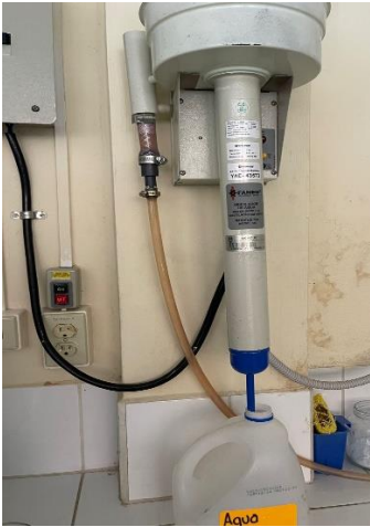
Anexo 1. Elaboración de agua destilada
