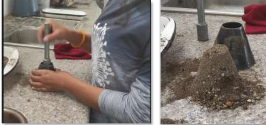
Ilustración 4: Ensayo de S.S.S
