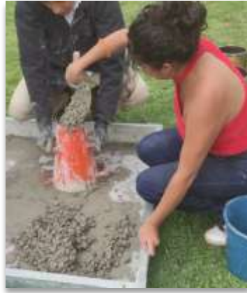
Ilustración 22: Ensayo del cono de Abrams
