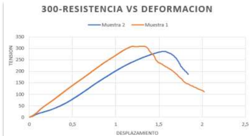
Gráfica 22 300kg/cm2 Esfuerzo vs Deformación del Agua Potable
