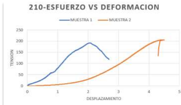
Gráfica 32 210kg/cm 2 Esfuerzo vs Deformación del Agua Quebrada.
