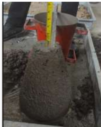
Ilustración 23: Medición de Asentamiento
