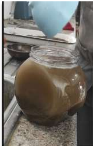
Ilustración 5: Picnómetro con muestra de arena
