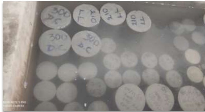
Ilustración 26 Curado del Hormigón
