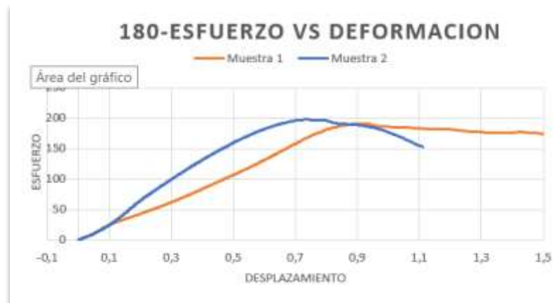
Gráfica 19: 180kg/cm 2 Esfuerzo vs Deformación del Agua Potable.
