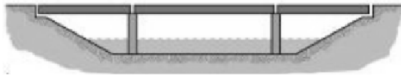
Ilustración 1 Puente Viga Losa
