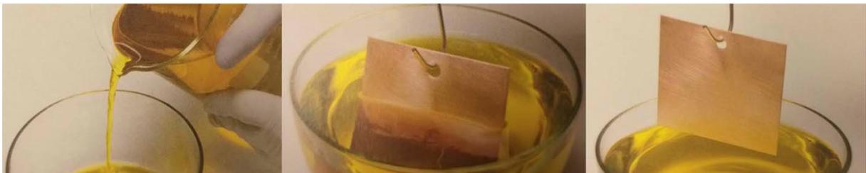
FIGURA 1.13: Proceso de oxidación inmersión en frío
