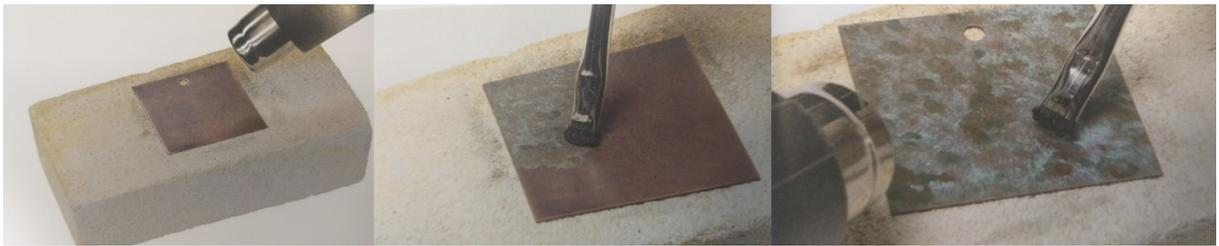
FIGURA 1.15: Aplicación por evaporación
