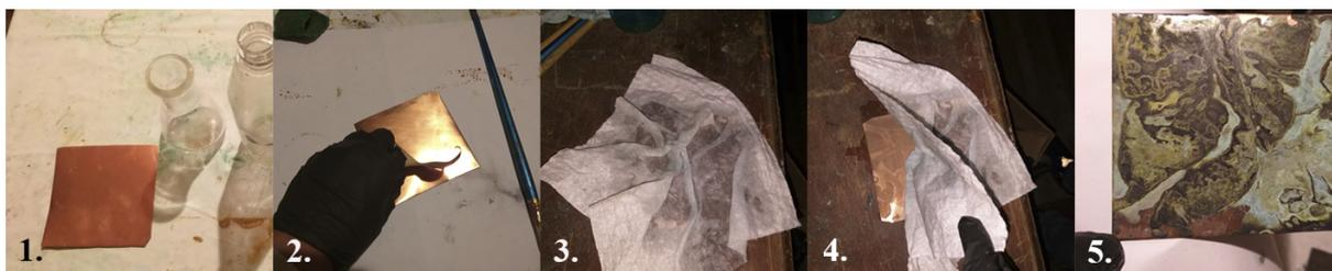
FIGURA 2.9: Proceso de elaboración de revestimiento verde texturizado
