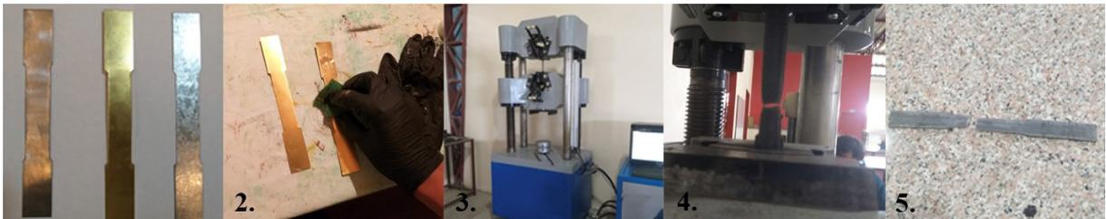
FIGURA 3.5: Proceso de ensayo de tracción
