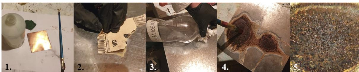
FIGURA 2.8: Proceso de elaboración de revestimiento azul
