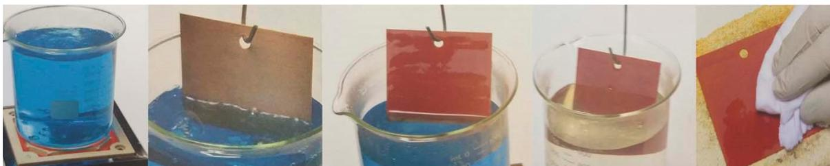
FIGURA 1.14: Proceso de oxidación inmersión en caliente
