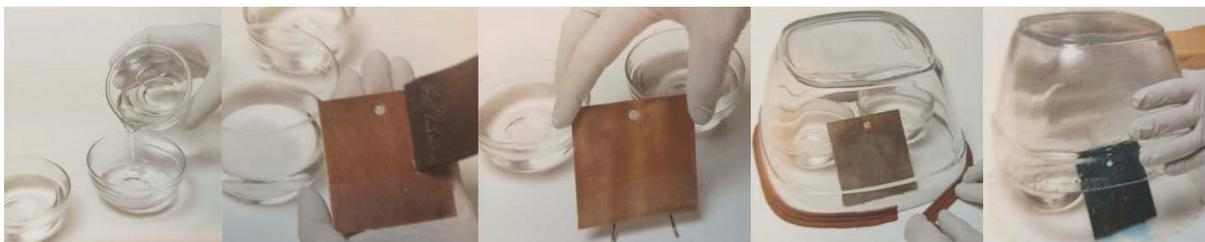
FIGURA 1.16: Aplicación por evaporación
