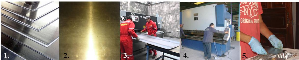
FIGURA 4.4: Proceso de elaboración del panel
