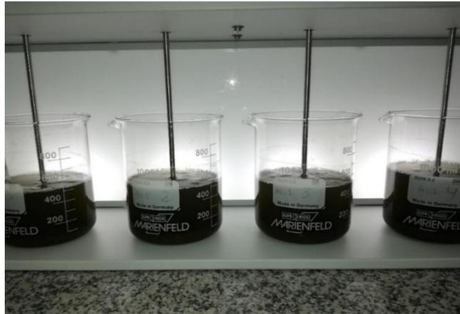
**Figura 5. Jar Test (Ensayo de Jarras).**
