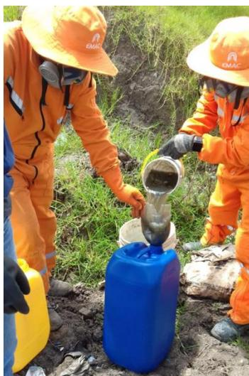
**Figura 3. Toma de muestras dentro del relleno.**
