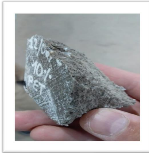
Anexo 14: Rotura de la probeta con el 10% de PET
