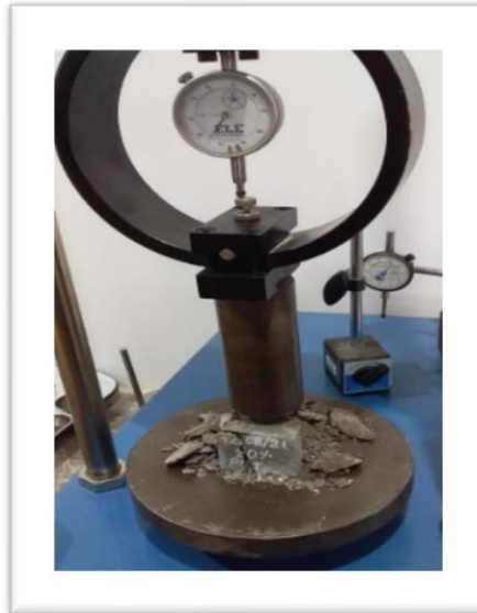
Figura 37: Rotura de probeta cubica con el 10% de PET a los 7 días
