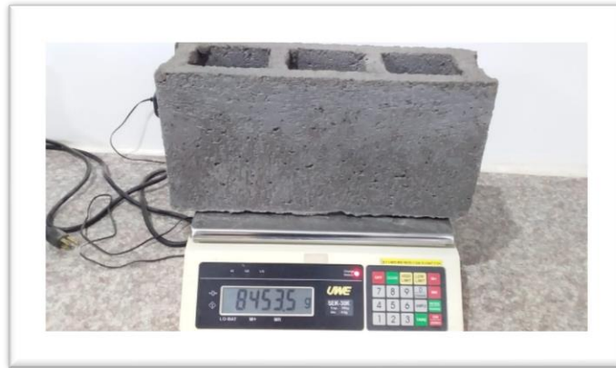
Figura 44: Peso del Bloque PET ejemplar # 1
