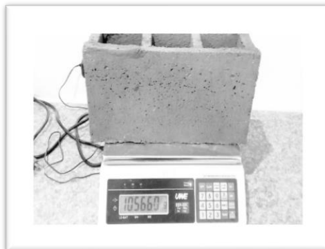
Figura 30: Peso del bloque pómez espécimen #1
