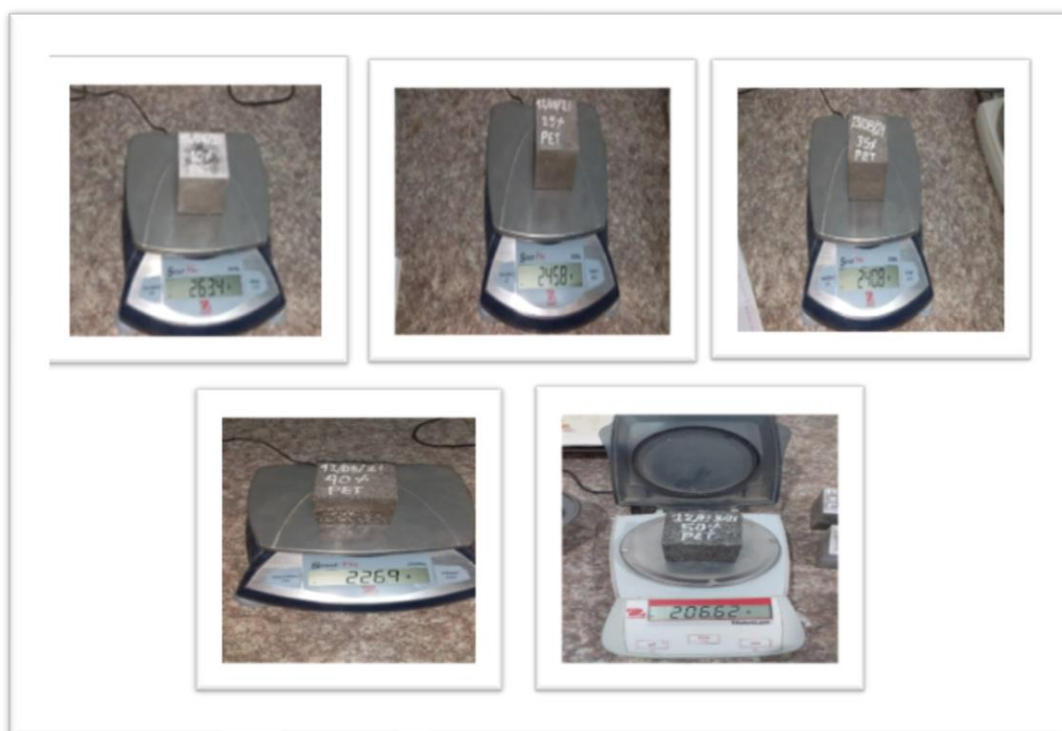
Figura 35: Peso de los especímenes con distintos porcentajes de PET.
