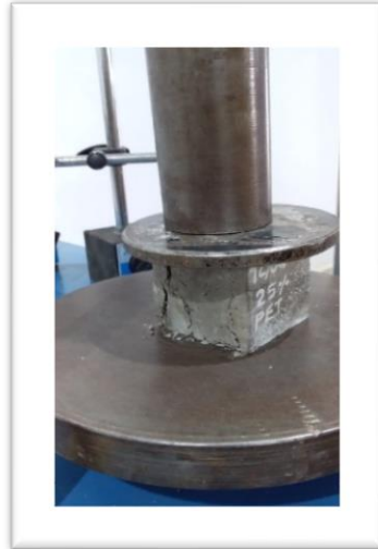
Figura 39: Rotura de probeta cubica con el 25% de PET a los 7 días
