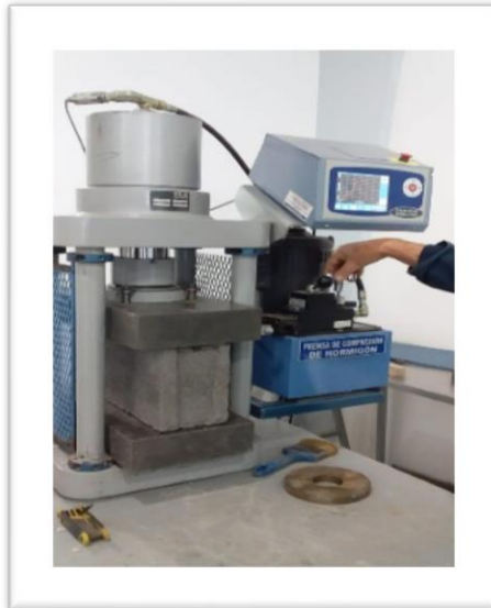
Anexo 9: Rotura de los bloques de hormigón
