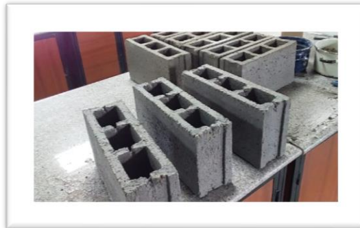
Figura 23: Bloques PET luego de dos días de fraguado
