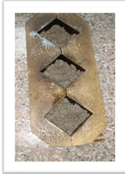
Figura 16: Llenado de probetas cubicas con adición del 25% de PET triturado
