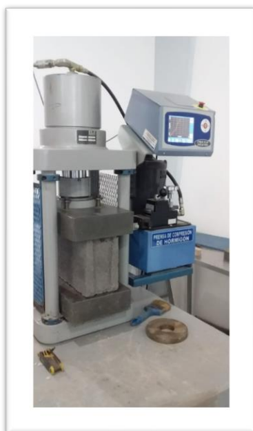
Figura 45: Rotura del bloque PET ejemplar 1
