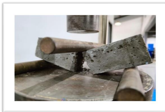
Figura 51: Rotura de la muestra al ensayo de flexión
