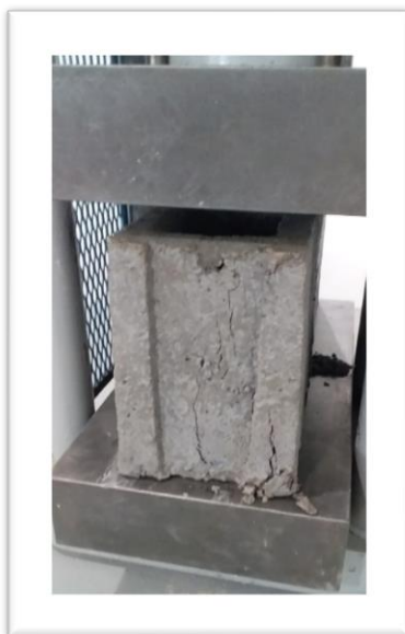
Figura 31: Rotura del bloque pómez espécimen #1
