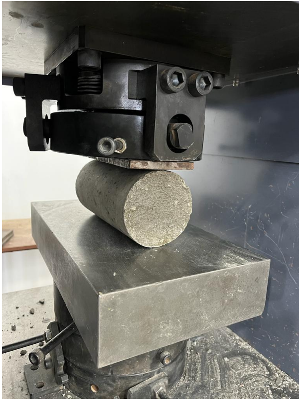
Figura 12 Ejemplo de ensayo tracción indirecta.
