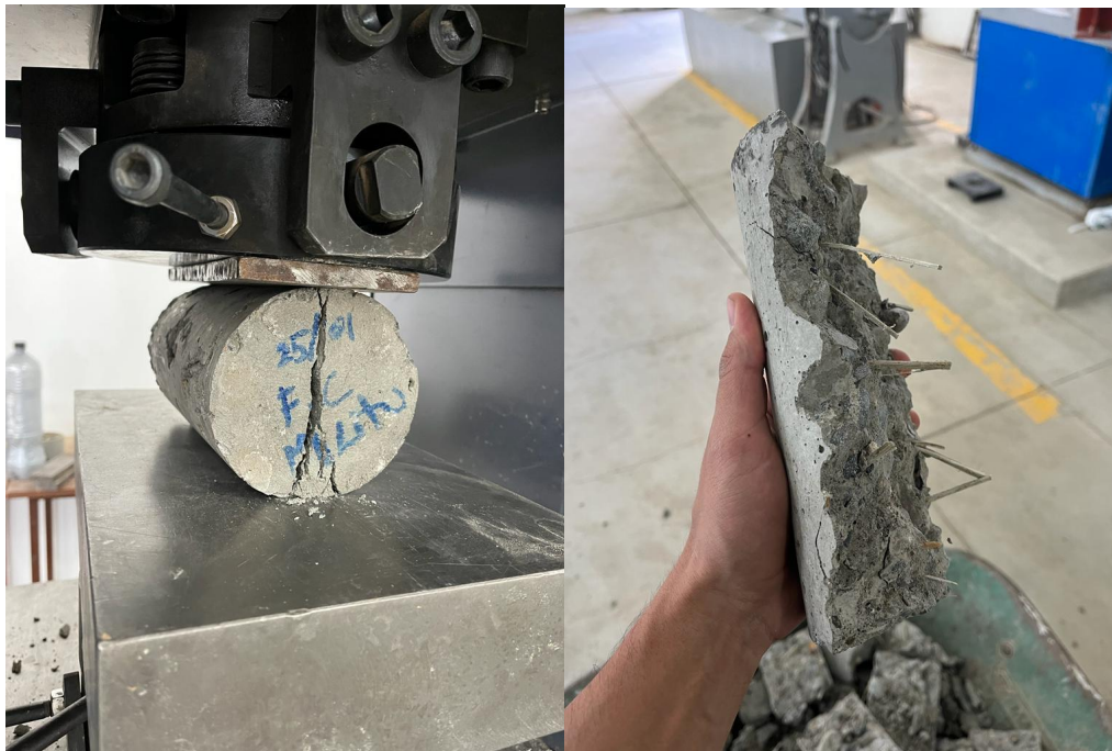
Figura 37 Tipo de falla a tracción indirecta.
