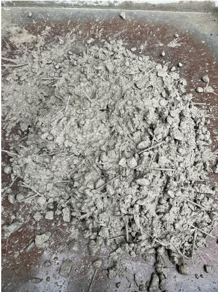
Figura 24 Hormigón con fibra.
