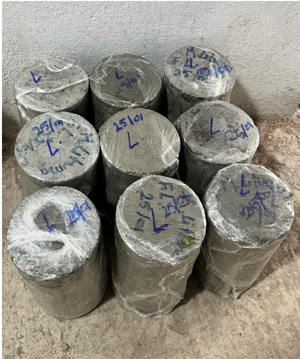
Figura 27 Método alternativo de curado de cilindros con fibras.
