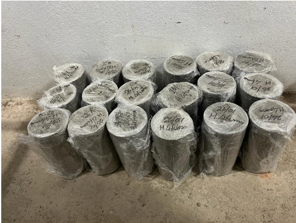
Figura 25 Proceso de curado de hormigón con fibra corta.
