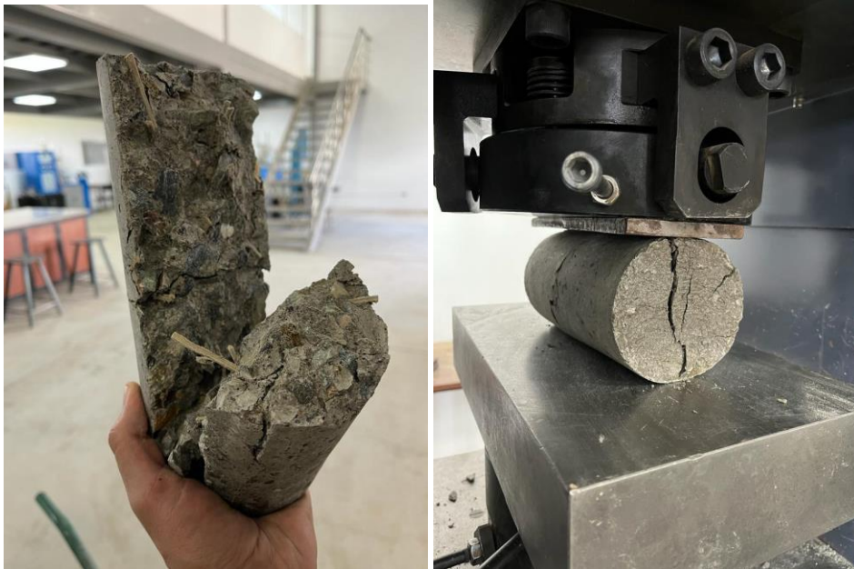
Figura 39 Tipo de falla a tracción indirecta.
