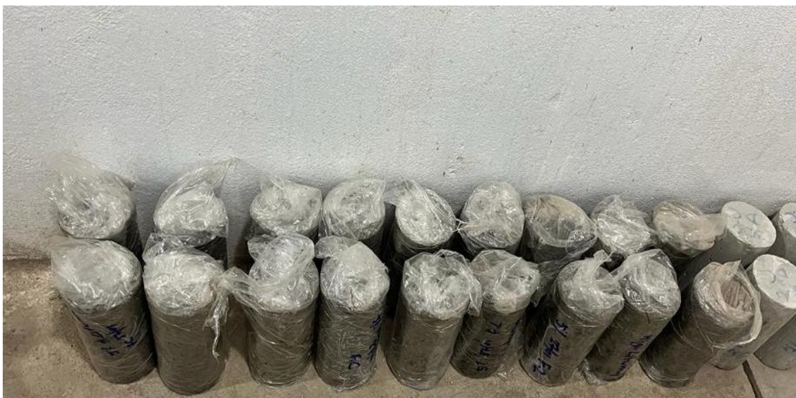
Figura 26 Proceso de curado de hormigón con fibra larga.
