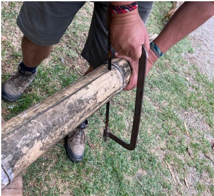
Figura 13 Proceso de corte de entrenudos.
