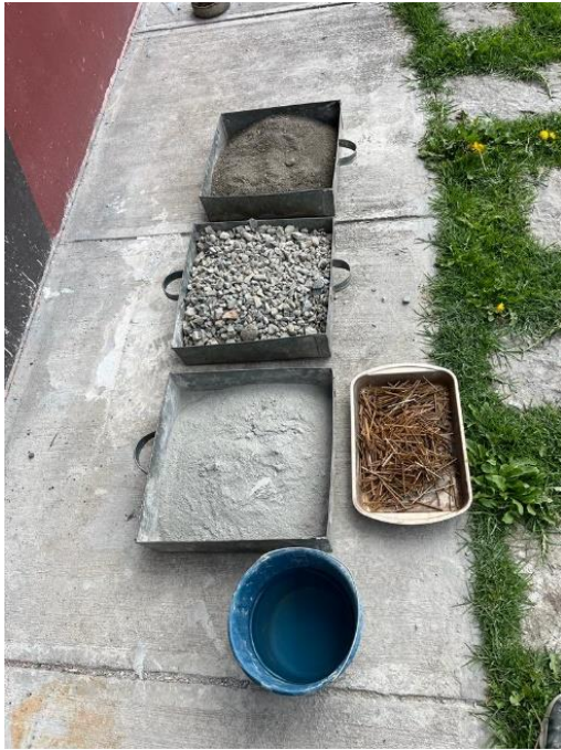
Figura 22 Materiales para hormigón con fibra.
