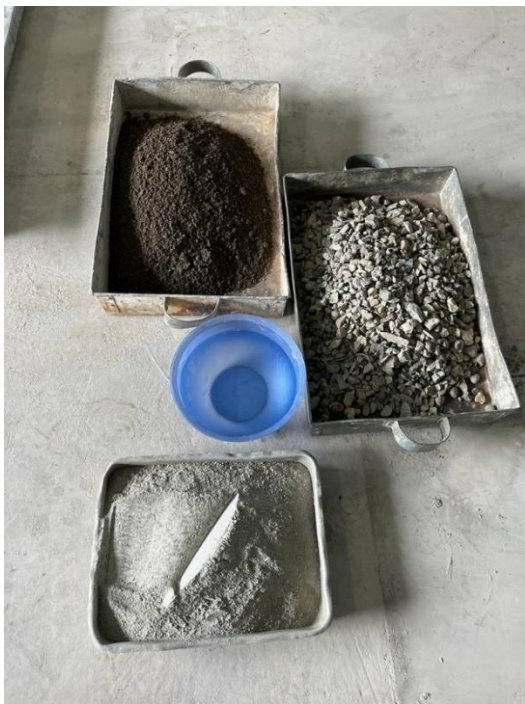
Figura 16 Materiales para mezcla de hormigón.
