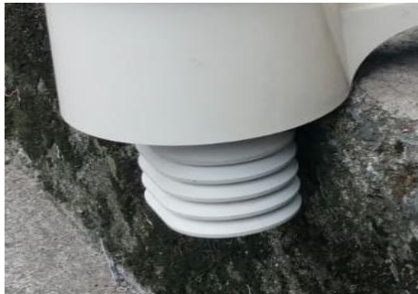
Figura 22: Sensor de temperatura y humedad. Fuente: Rene Brito-Luis Saldaña, autores.
