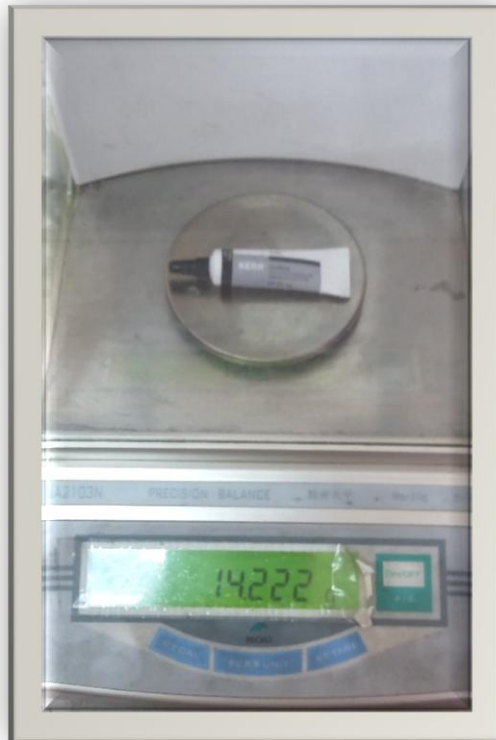
Fotografía tomada por el autor. Pablo Chiriboga. Pesaje de Dical Catalyst vacío.
