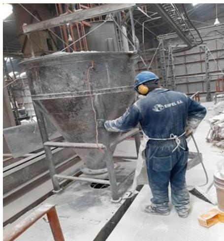
*Imagen 18:* Descarga de Material en los Mezcladores
