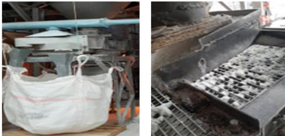
*Imagen 74:* Ensacado de Frita Big Bag, Clasificador, Vibrador (Pineiras)
