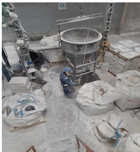
*Imagen 8: Colocación de la tolva en la Báscula*
