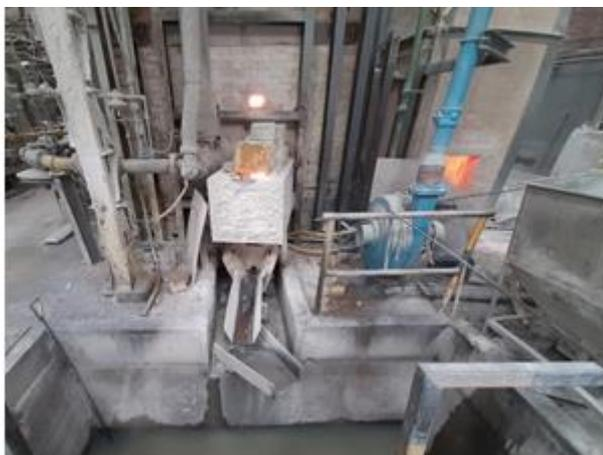
*Imagen 42:* Precalentamiento del Horno
