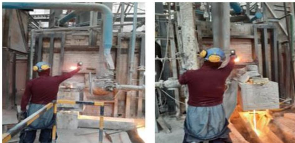
*Imagen 52:* Toma de Temperaturas Horno C2, Horno C3
