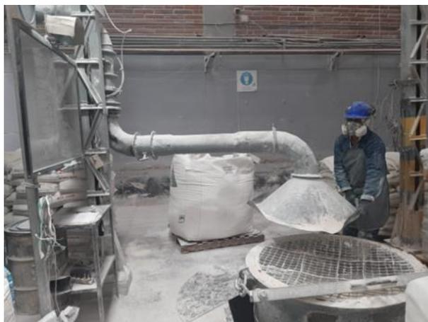
*Imagen 9:* Colocación de la Campana del Extractor en la Tolva
