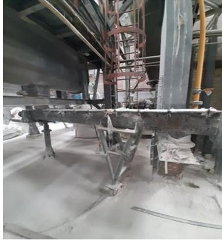
*Imagen 24: Unión y sellado de la rosca transportadora y el elevador de cangilones*
