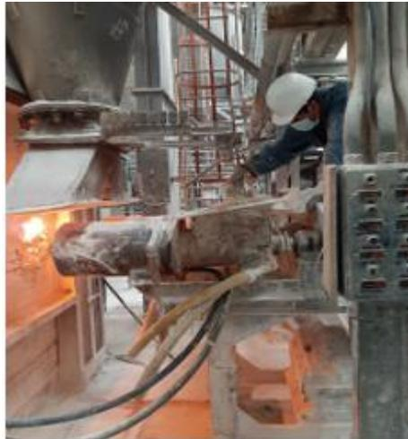
*Imagen 46: Colocación de las Pasta en las Tolvas del Carro Alimentador*
