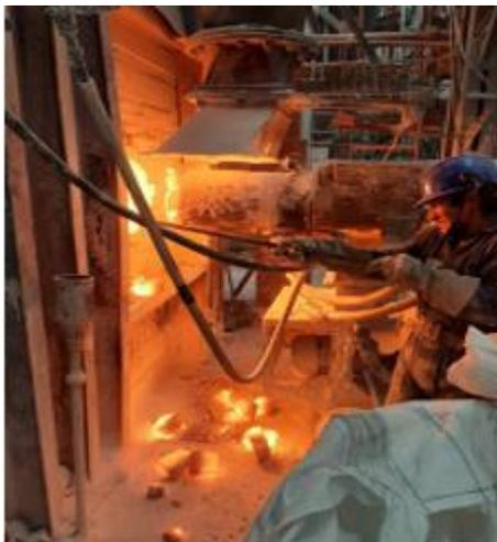
*Imagen 44:* Despeje de las Entradas de Horno
