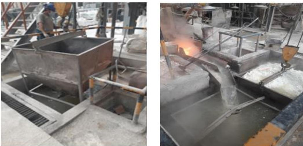
*Imagen 66:* Colocación de la Segunda Canastilla en las Fosas, Cambio de Desfogue de Frita
