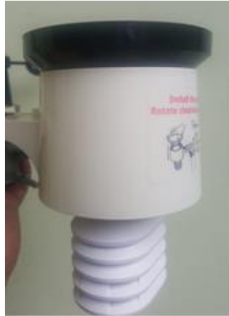
Fig. 59 Sensor de Humedad, Temperatura y Pluviómetro de Estación Meteorológica
