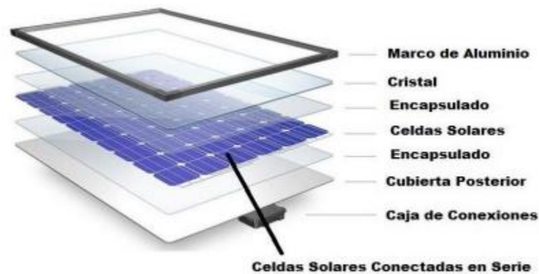
Fig. 14 Componentes de un Panel Solar
