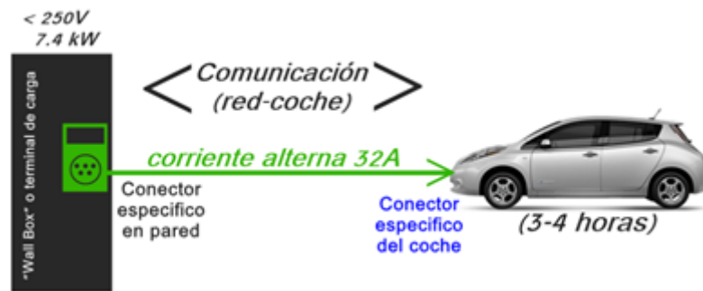
Fig. 37 Modo 3 de Recarga
