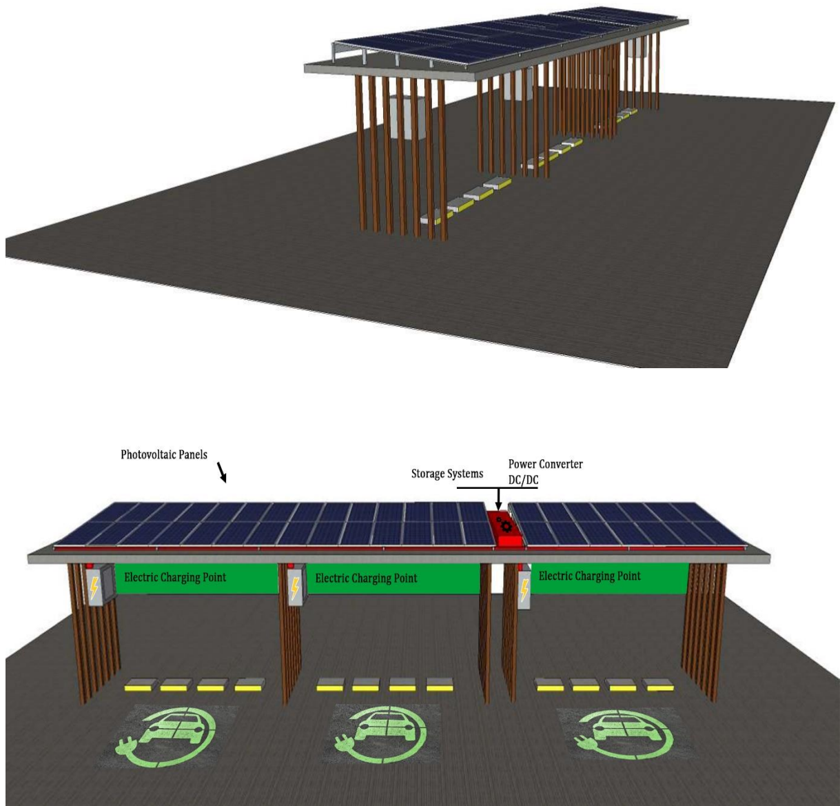
Fig. 136 Arquitectura, Estación de Carga – Electrolinera.
