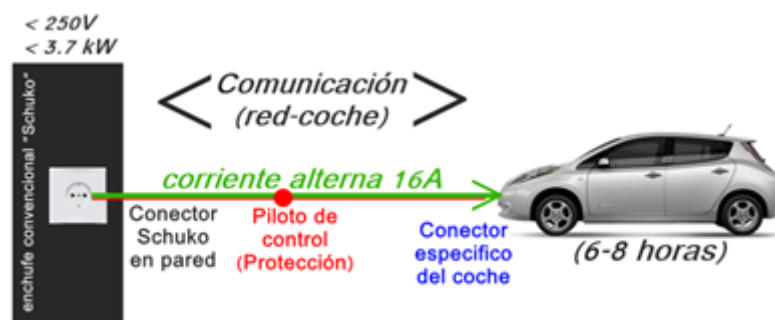
Fig. 36 Modo 2 de Recarga
