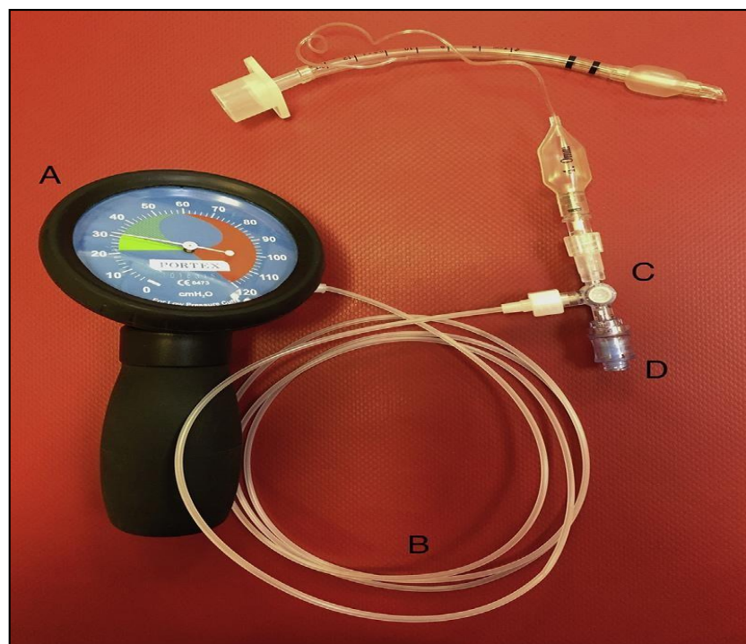
Fig. 7 Manómetro para la medición de la presión intrabucal para el inflado del manguito del tubo endotraqueal. Su configuración permitió establecer una presión de 30 cmH 2 O en el manguito endotraqueal antes de que se registrara la presión de fuga. A, manómetro; B,
