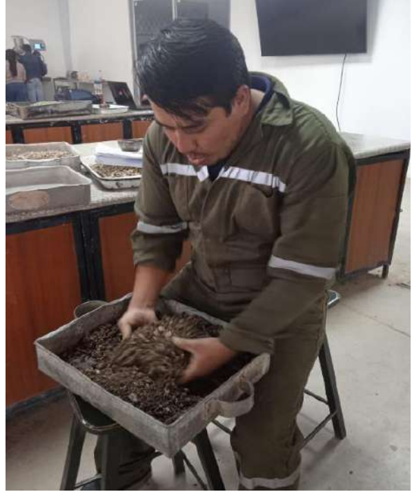
Foto 6: Mezcla Humedad Optima.
