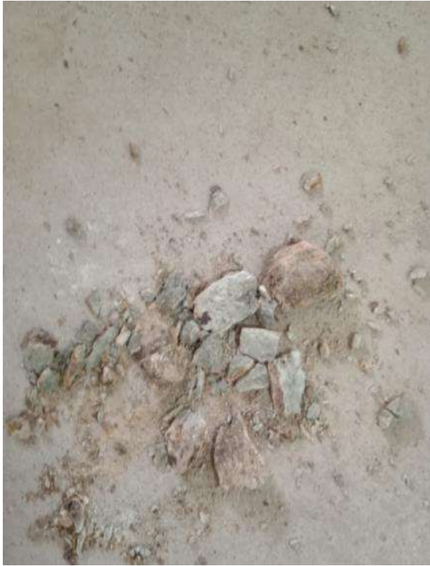
Foto 9: Material Grueso al Compactar
