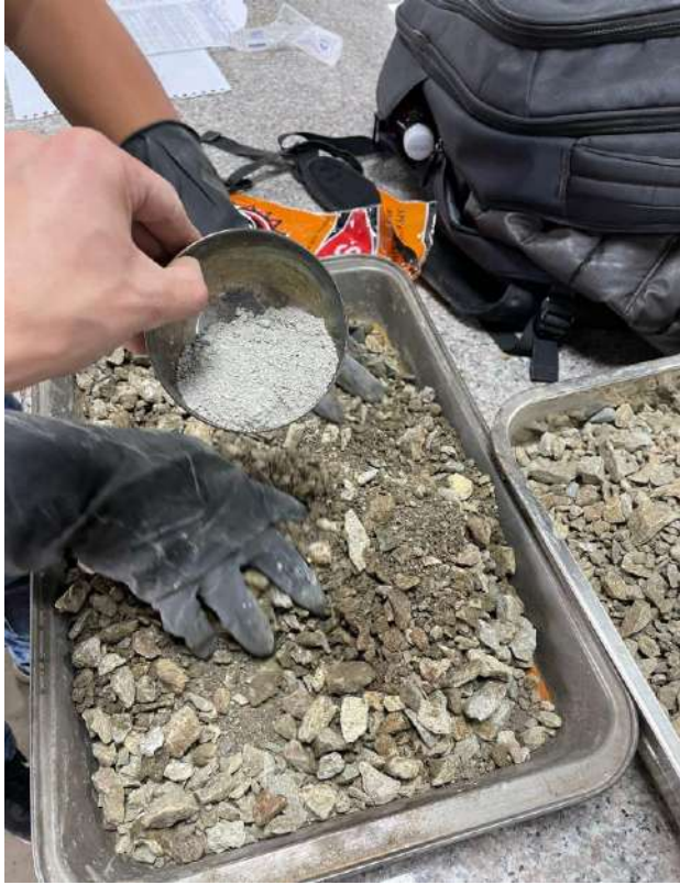
Foto 21: Incorporación de cemento a la muestra
