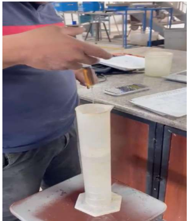
Foto 20: Aditivo incorporado al agua
