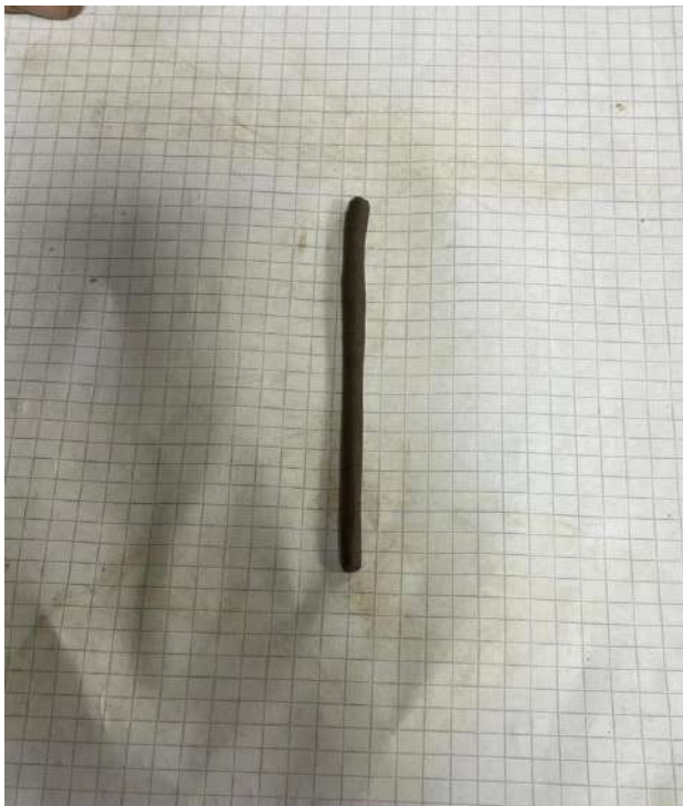
Foto 23: Ensayo Límite plástico
