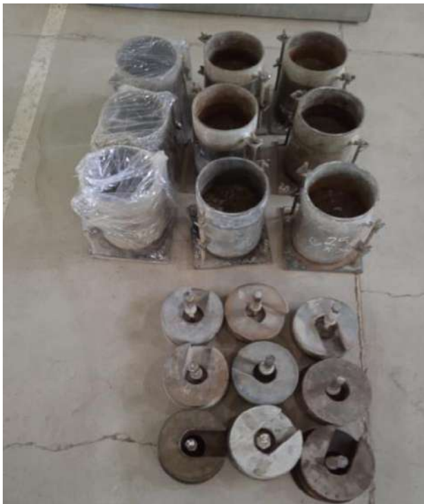
Foto 11: Ensayo CBR más Aditivo.
