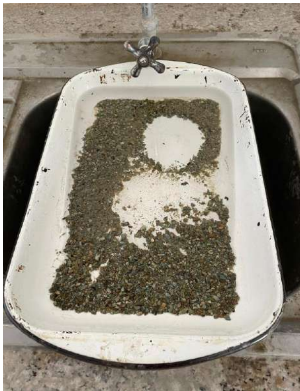
Foto 26: Material después del lavado
