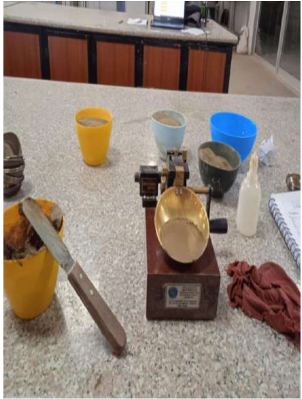
Foto 10: Limites de Atterberg con Aditivo.
