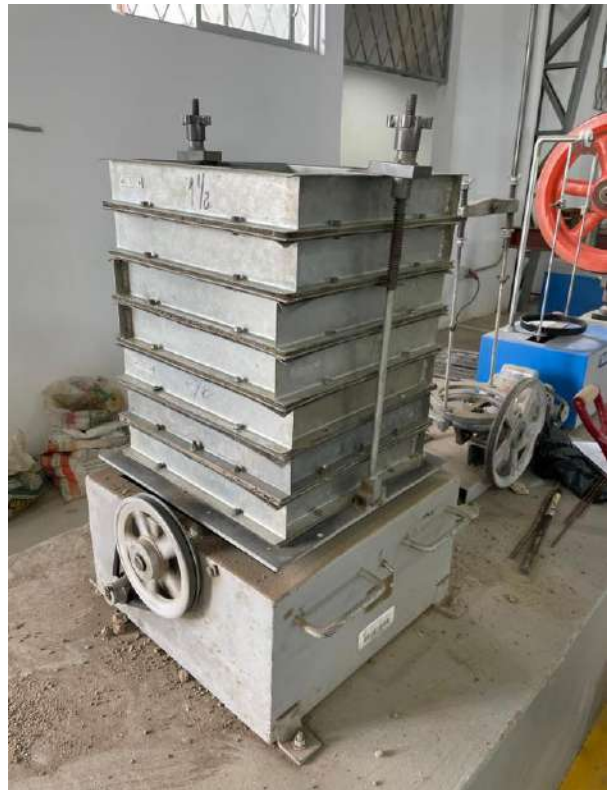
Foto 16: Ensayo de Granulometría
