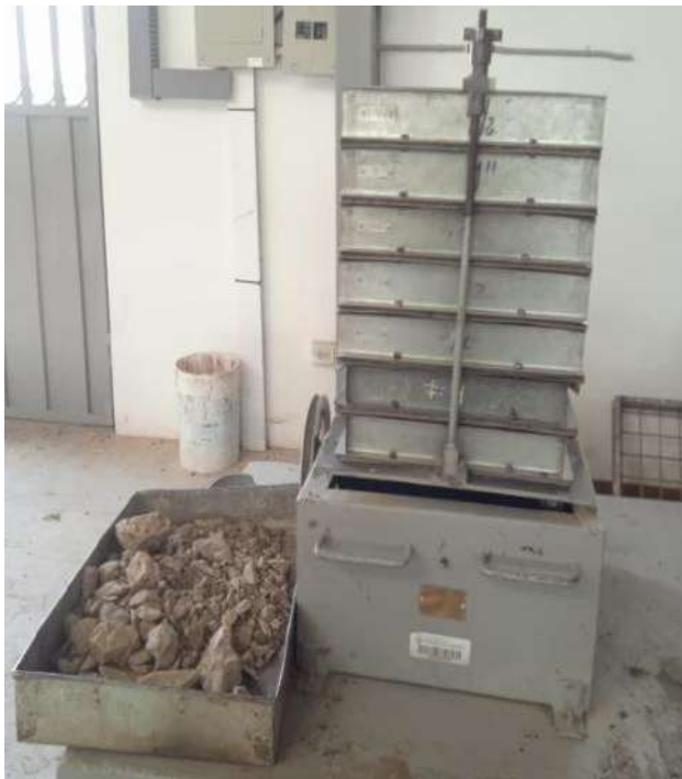
Foto 3: Tamizado de Material.
