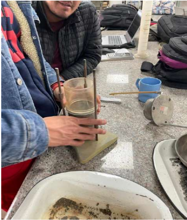
Foto 29: Armado de permeámetro
