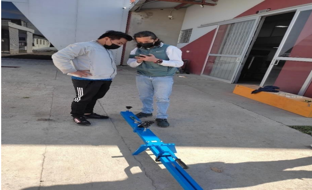
Ilustración 5: Calibrar los extensómetros.
