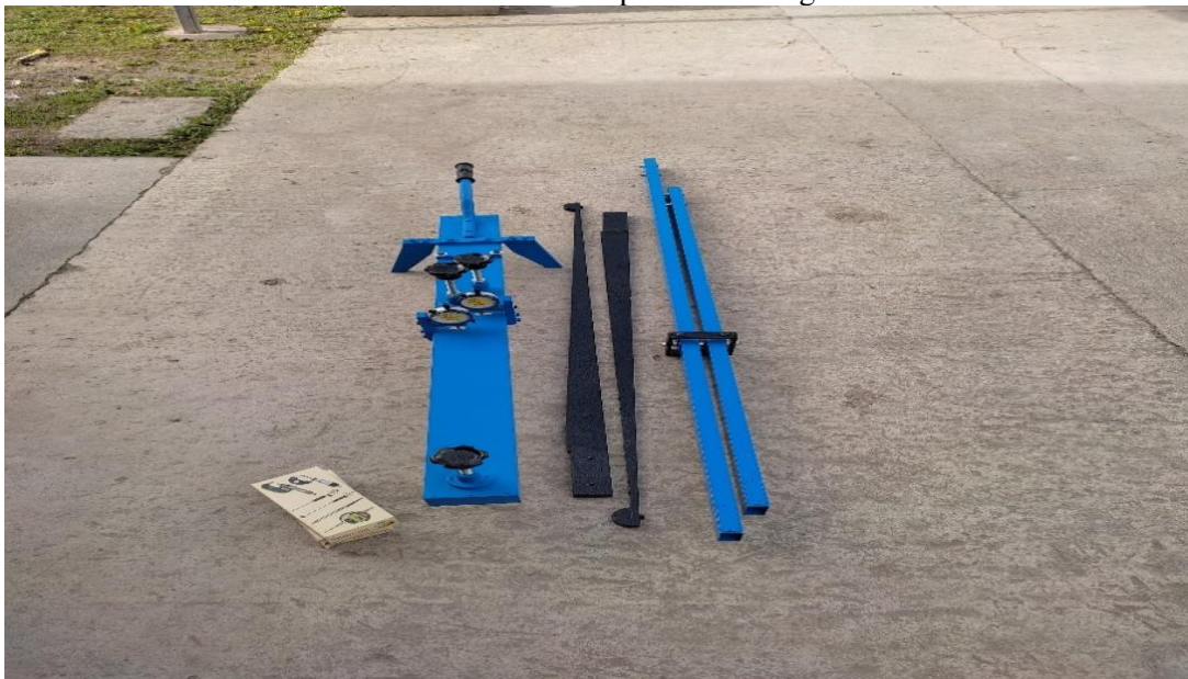
Ilustración 2: Identificación de partes de la viga Benkelman.
