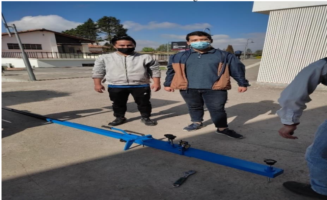
Ilustración 6: Armado de la viga Benkelman.
