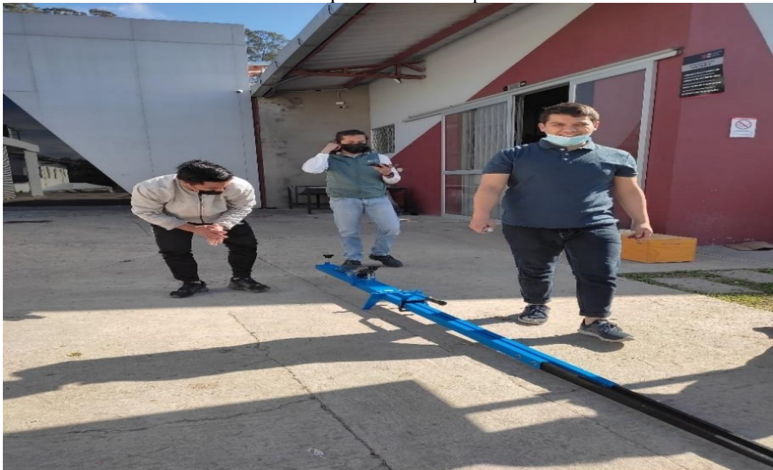
Ilustración 4: Verificar que el vibrador tope los brazos móviles.
