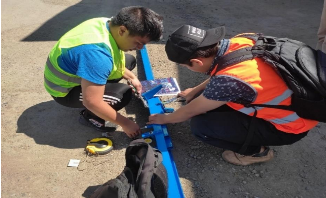
Ilustración 7: Calibración de la Viga Benkelman.
