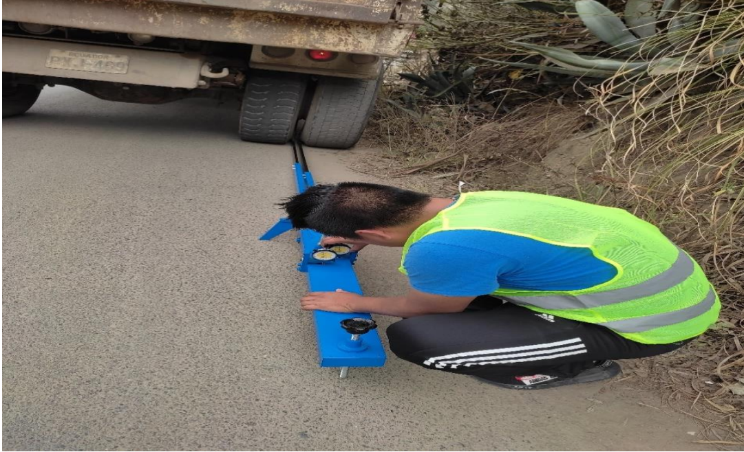
Ilustración 13: Calibración de los extensómetros en cada abscisa.
