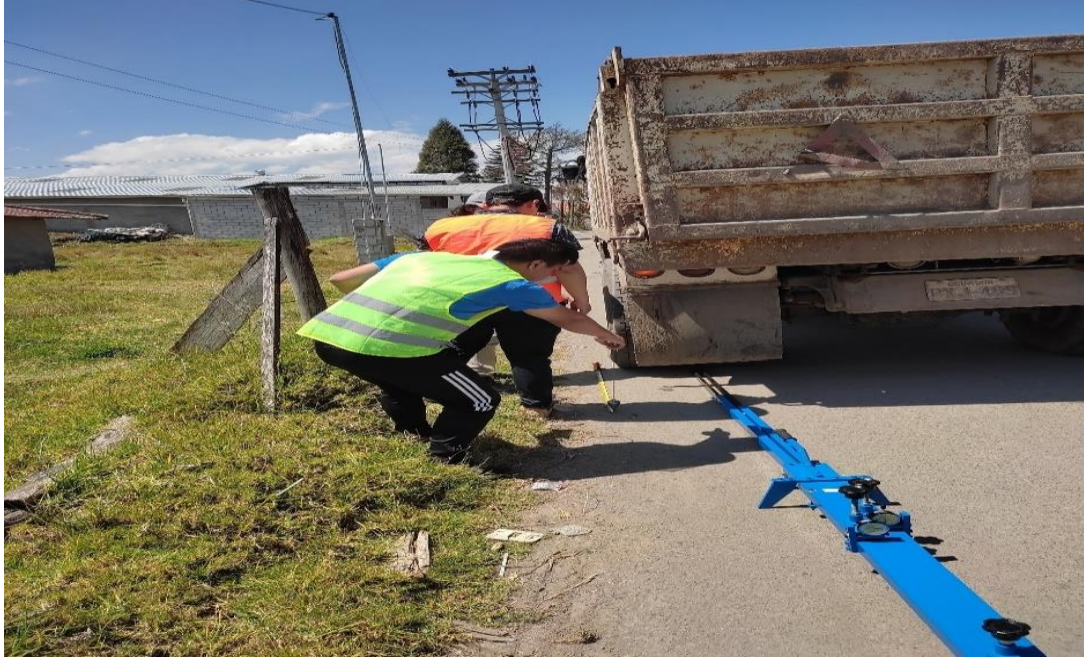
Ilustración 9: Ubicación de la viga debajo del eje vertical de las llantas.
