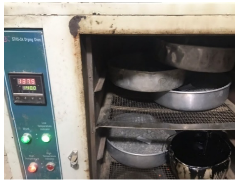
Figura 2. Materiales con polvo de caucho: (a) materiales con los 4 porcentajes de polvo de caucho; (b) introducción de materiales en el horno por 24 horas.
