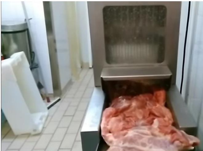
Ilustración 15. Inyección de la salmuera
