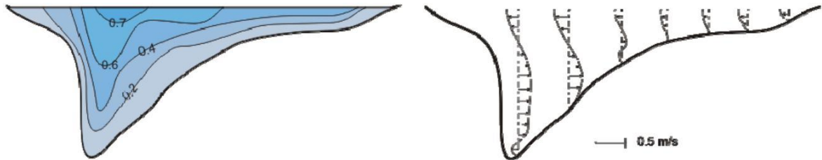
Figura 2.9: Distribución de velocidades del flujo en dirección a) principal y, b) transversal de un río
