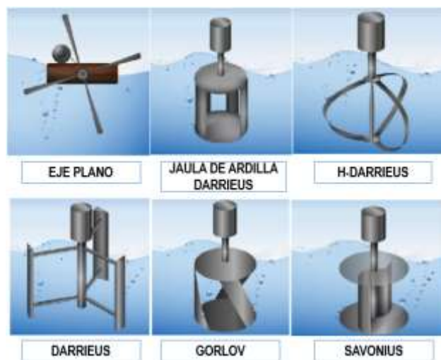
Figura 24: Turbinas hidrocineéticas de eje vertical. Fuente: (Cardona et al., 2018)
