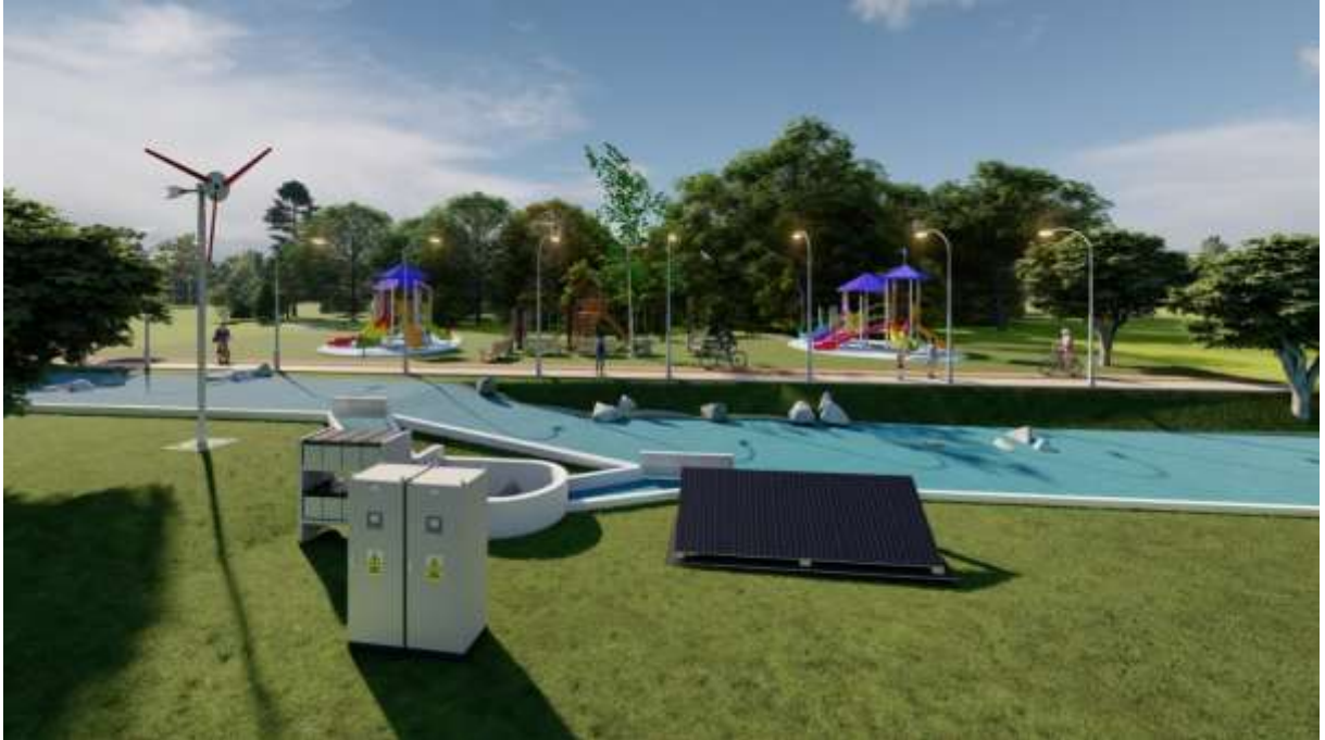
Figura 150: Diseño final 2 del Sistema Híbrido PV/WT/HKT mediante los programas SketchUp-ArchiCAD-Lumion (3/8). Fuente: El Autor
