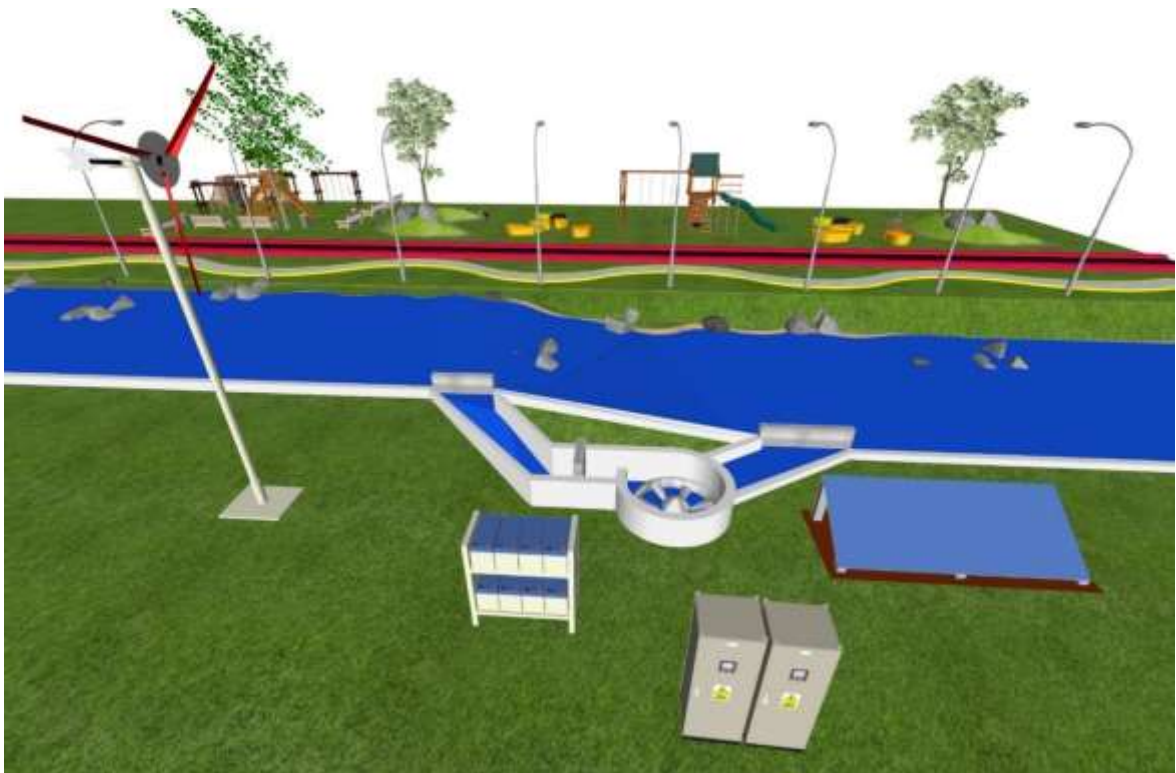
Figura 142: Diseño final 1 del Sistema Híbrido PV/WT/HKT mediante los programas SketchUp-ArchiCAD-Lumion (2/7). Fuente: El Autor
