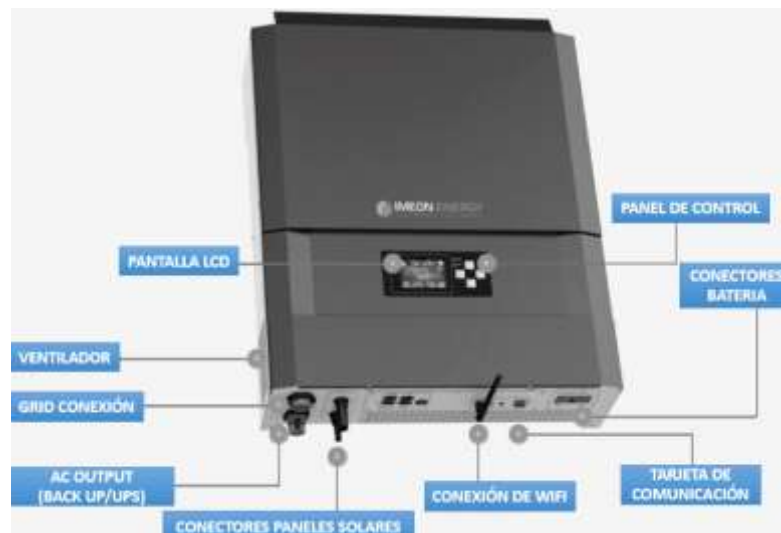
Figura 32: Partes del Inversor IMEON. Fuente: (Imeon, 2022)
