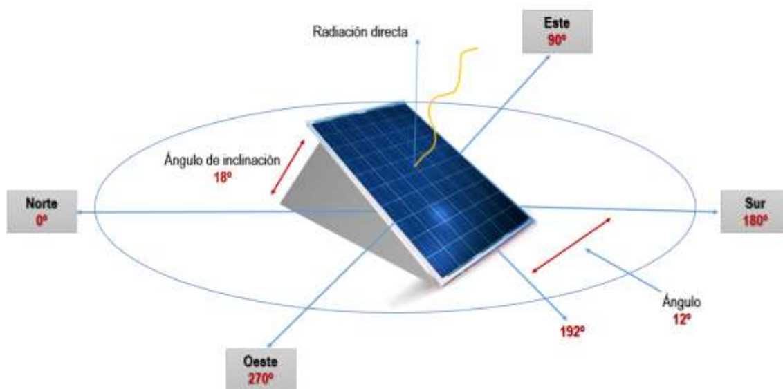
Figura 21: Orientación e Inclinación de Paneles Solares. Fuente: El Autor
