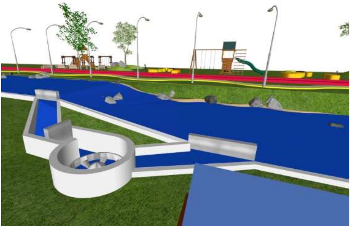
Figura 141: Diseño final 1 del Sistema Híbrido PV/WT/HKT mediante los programas SketchUp-ArchiCAD-Lumion (1/7). Fuente: El Autor
