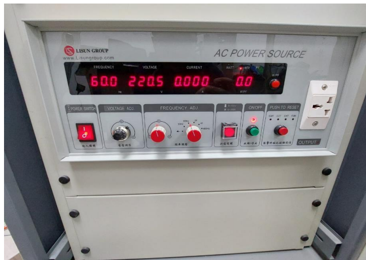
Figura 61. Calibración del módulo de alimentación (LINSU GROUP).
