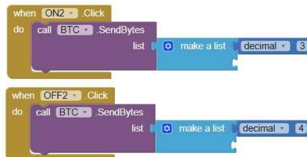
Figura 55. Programación por bloques de “ON_LED_2 y OFF_LED_2”.
