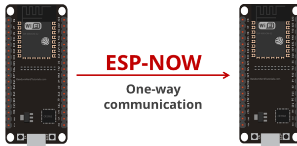
Figura 21. Conexión entre dispositivos (ESP-32) mediante el protocolo ESP-NOW.
