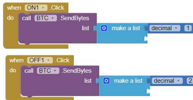
Figura 54. Programación por bloques de “ON_LED_1 y OFF_LED_1”.
