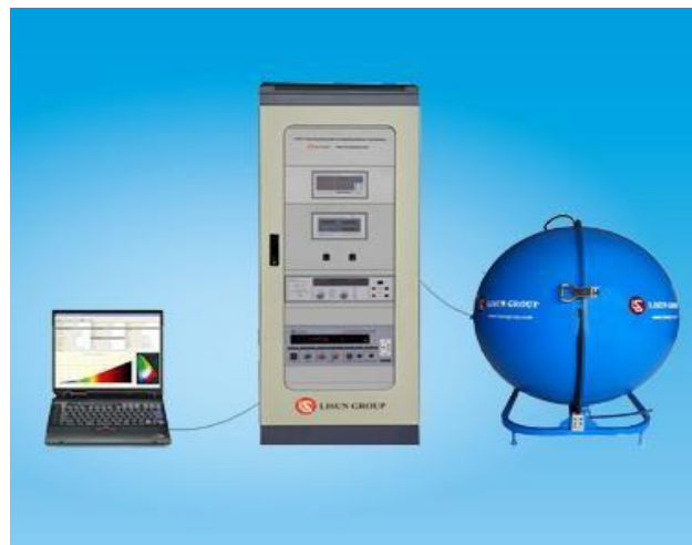
Figura 30. LPCE-2 (LMA-9000) sistema de esfera integradora de espectrorradiómetro.
