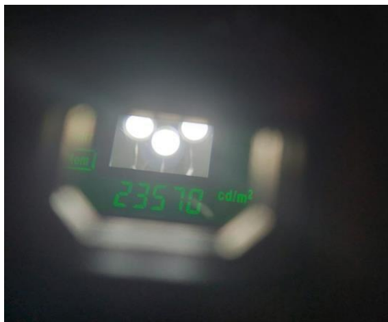
Figura 71. Medida de iluminancia de la fuente luminosa de 12W/220W.
