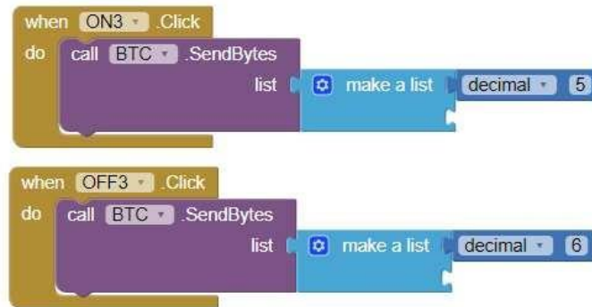
Figura 56. Programación por bloques de "ON_LED_3 y OFF_LED_3".
