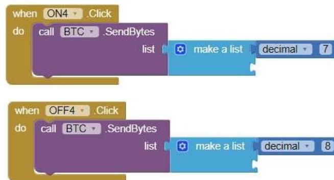
Figura 57. Programación por bloques de "ON_LED_4 y OFF_LED_4".
