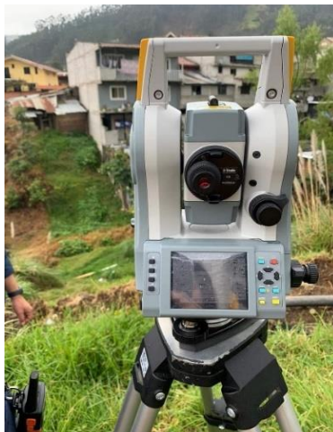
Figura 12. Equipo utilizado en el levantamiento topográfico
