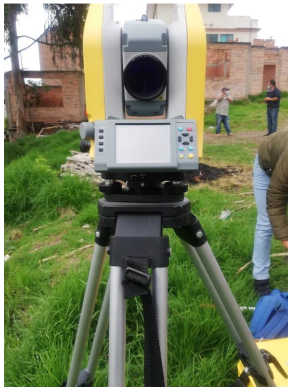
Figura 8. Estación total para obtención de puntos coordenadas
