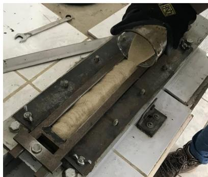
*Ilustración 133* Colocación de arena Ottawa en muestra.
