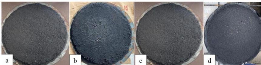
**Ilustración 128** Resultados del ensayo de abrasión en húmedo mina Vipesa-CQS-1H-P a) Muestra seca antes del ensayo b) Muestra seca después del ensayo, saturada 1 hora c) Muestra seca antes del ensayo d) Muestra seca después del ensayo, saturada 6 días.
