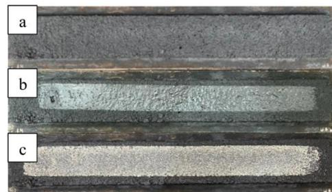
**Ilustración 151** Resultados del ensayo de rueda cargada mina vipesa-CQS-1H-P a) Muestra seca antes del ensayo b) Muestra seca después del ensayo, 1000ciclos c) Muestra seca después del ensayo, 100 ciclos con arena Ottawa.
