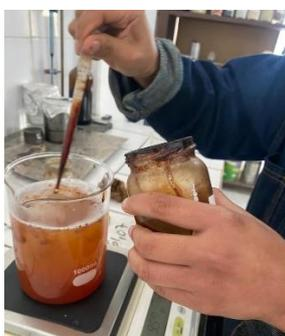
**Ilustración 61** Colocación de emulsificante Surfax C-60
