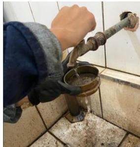
**Ilustración 74** Lavado de residuo en tamiz
