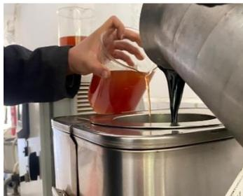
**Ilustración 65** Mezclado solución jabonosa y asfalto aditivado
