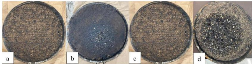
**Ilustración 114** Resultados del ensayo de abrasión en húmedo mina Rookaazul CQS-1H-PU
