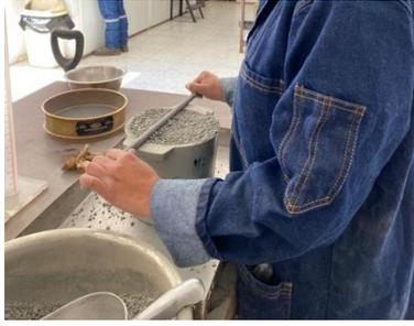
**Ilustración 19.** Enrazado de muestra
