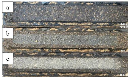
**Ilustración 138** Resultados del ensayo de rueda cargada mina Rookaazul CQS-1H-PU a) Muestra seca antes del ensayo b) Muestra seca después del ensayo, 1000ciclos c) Muestra seca después del ensayo, 100 ciclos con arena Ottawa.
