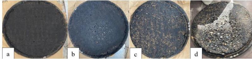
**Ilustración 117** Resultados del ensayo de abrasión en húmedo mina Rookaazul CQS-1H-PU a) Muestra seca antes del ensayo b) Muestra seca después del ensayo, saturada 1 hora c) Muestra seca antes del ensayo d) Muestra seca después del ensayo, saturada 6 días.
