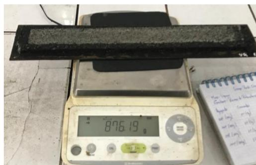
**Ilustración 136** Peso de la muestra después del ensayo
