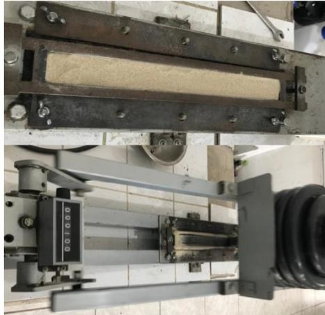
**Ilustración 134** Muestra en maquina rueda cargada (100 ciclos).
