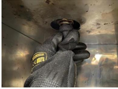
**Ilustración 68** Insertando tapón en la cámara del viscosímetro
