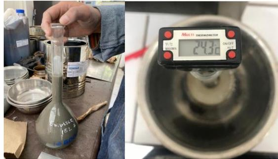
**Ilustración 27.** Eliminando burbujas y baño María de la muestra
