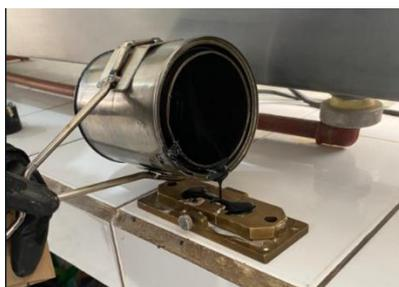
**Ilustración 41** Verter material en el molde
