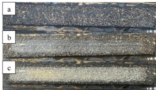
**Ilustración 142** Resultados del ensayo de rueda cargada mina Vipesa CQS-1H-PU a) Muestra seca antes del ensayo b) Muestra seca después del ensayo, 1000ciclos c) Muestra seca después del ensayo, 100 ciclos con arena Ottawa
