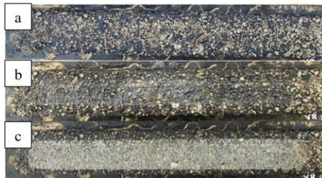
**Ilustración 144** Resultados del ensayo de rueda cargada mina Vipesa CQS-1H-PU a) Muestra seca antes del ensayo b) Muestra seca después del ensayo, 1000ciclos c) Muestra seca después del ensayo, 100 ciclos con arena Ottawa.
