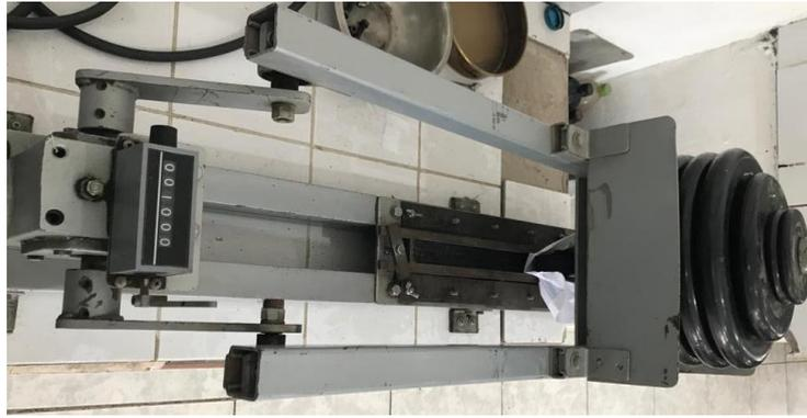
*Ilustración 131* Ensayo de rueda cargada (1000 ciclos)
