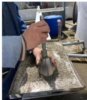
**Ilustración 24.** Compactando muestra con pistón
