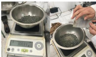
**Ilustración 92** Pesar agregado para la mezcla
