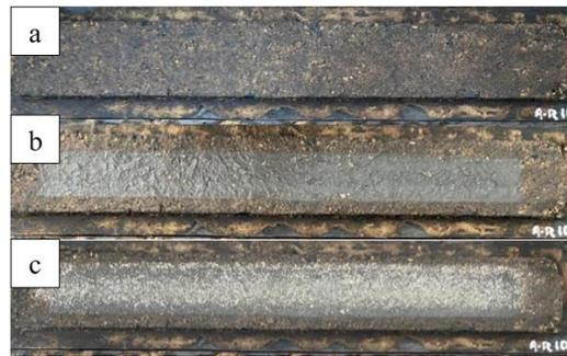
**Ilustración 137** Resultados del ensayo de rueda cargada mina Rookaazul CQS-1H-PU a) Muestra seca antes del ensayo b) Muestra seca después del ensayo, 1000ciclos c) Muestra seca después del ensayo, 100 ciclos con arena Ottawa.
