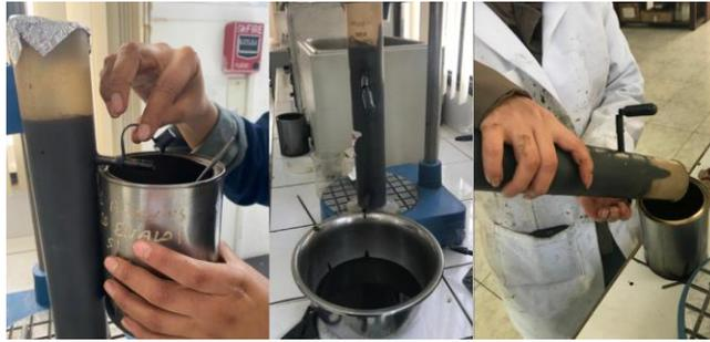
**Ilustración 71** Secuencia de extracción de muestra superior e inferior
