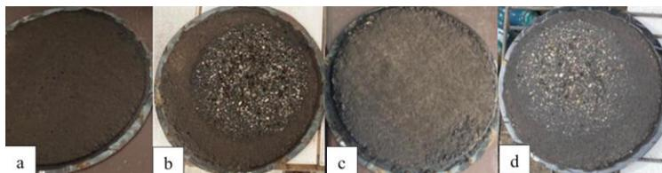
**Ilustración 121** Resultados del ensayo de abrasión en húmedo mina Rookaazul-CQS-1H-P a) Muestra seca antes del ensayo b) Muestra seca después del ensayo, saturada 1 hora c) Muestra seca antes del ensayo d) Muestra seca después del ensayo, saturada 6 días.
