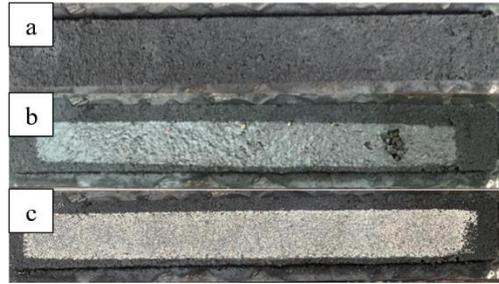
**Ilustración 152** Resultados del ensayo de rueda cargada mina vipesa-CQS-1H-P a) Muestra seca antes del ensayo b) Muestra seca después del ensayo, 1000 ciclos c) Muestra seca después del ensayo, 100 ciclos con arena Ottawa.
