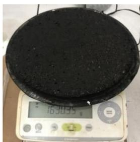
**Ilustración 110** Peso de la muestra seca antes del ensayo
