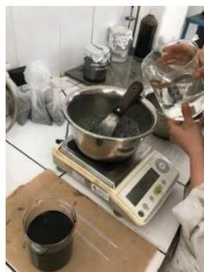
***Ilustración 85*** Mezcla para ensayo de consistencia
