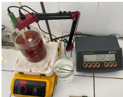
**Ilustración 62** Solución Jabonosa con pH de 2 y Temperatura de 40°C
