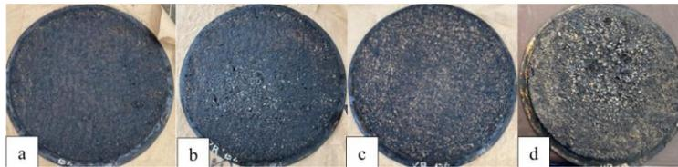
**Ilustración 120** Resultados del ensayo de abrasión en húmedo mina Vipesa CQS-1H-PU a) Muestra seca antes del ensayo b) Muestra seca después del ensayo, saturada 1 hora c) Muestra seca antes del ensayo d) Muestra seca después del ensayo, saturada 6 días.
