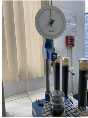
**Ilustración 55** Equipo para ensayo de Penetración
