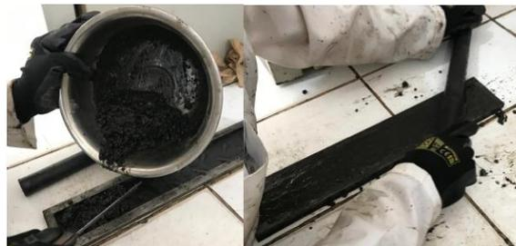
**Ilustración 130** Muestra en moldes para ensayo de rueda cargada
