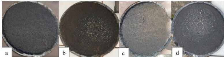
**Ilustración 123** Resultados del ensayo de abrasión en húmedo mina Rookaazul-CQS-1H-P a) Muestra seca antes del ensayo b) Muestra seca después del ensayo, saturada 1 hora c) Muestra seca antes del ensayo d) Muestra seca después del ensayo, saturada 6 días.
