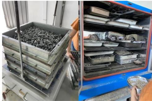
**Ilustración 21.** Tamizaje y secado de las muestras
