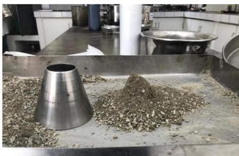
**Ilustración 25.** Ensayo Gravedad específica por medio del Picnómetro
