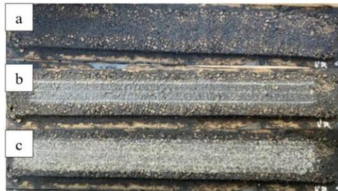
**Ilustración 141** Resultados del ensayo de rueda cargada mina Vipesa CQS-1H-PU a) Muestra seca antes del ensayo b) Muestra seca después del ensayo, 1000ciclos c) Muestra seca después del ensayo, 100 ciclos con arena Ottawa.
