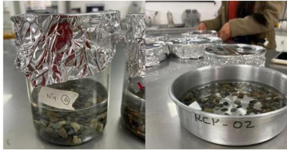
**Ilustración 15.** Muestras sumergidas en solución de sulfato de sodio
