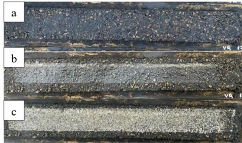
**Ilustración 143** Resultados del ensayo de rueda cargada mina Vipesa CQS-1H-PU a) Muestra seca antes del ensayo b) Muestra seca después del ensayo, 1000ciclos c) Muestra seca después del ensayo, 100 ciclos con arena Ottawa.
