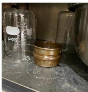
**Ilustración 75** Secado de tamiz con residuo en horno
