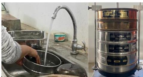
**Ilustración 14.** Lavado y Tamizado de muestras
