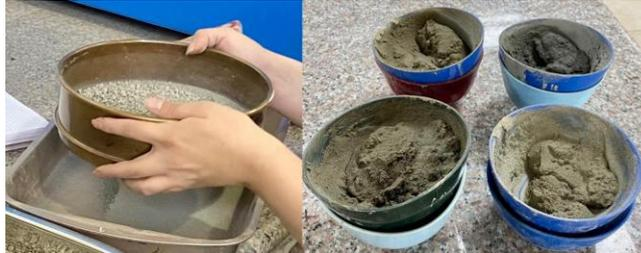
**Ilustración 10.** Muestras tamizadas y saturadas
