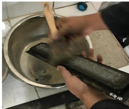
**Ilustración 135** Retirar exceso de arena Ottawa después del ensayo.
