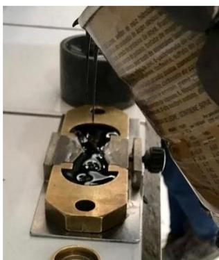
**Ilustración 37** Material vertido en el molde
