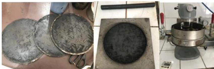
**Ilustración 106** Herramientas para ensayo de abrasión en húmedo disco de ensayo, molde y equipo
