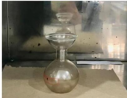
**Ilustración 69** Alineación del vaso receptor
