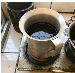
**Ilustración 64** Calentar el asfalto hasta una temperatura de 140°C
