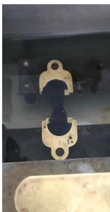
**Ilustración 39** Anillos enganchados para realizar ensayo de ductilidad
