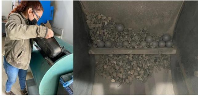
**Ilustración 22.** Ensayo con máquina de Los Ángeles
