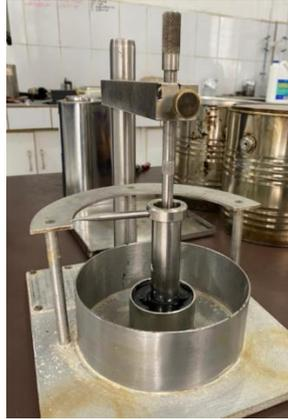
**Ilustración 44** Muestra para ensayo de recuperación torsional
