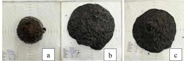
**Ilustración 88** Resultados ensayo de contenido de humedad optima mina Rookaazul CQS-1H-PU a) Mezcla con 16% Agua b) Mezcla con 14% Agua, c) Mezcla con 18% Agua
