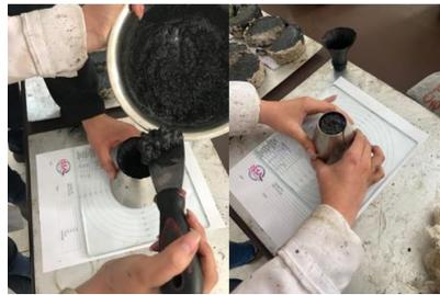
**Ilustración 87** Ensayo de consistencia
