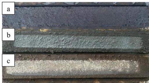
**Ilustración 145** Resultados del ensayo de rueda cargada mina Rookaazul-CQS-1H-P a) Muestra seca antes del ensayo b) Muestra seca después del ensayo, 1000ciclos c) Muestra seca después del ensayo, 100 ciclos con arena Ottawa.
