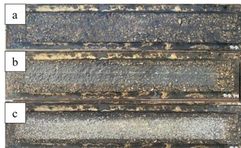
**Ilustración 139** Resultados del ensayo de rueda cargada mina Rookaazul CQS-1H-PU a) Muestra seca antes del ensayo b) Muestra seca después del ensayo, 1000ciclos c) Muestra seca después del ensayo, 100 ciclos con arena Ottawa.
