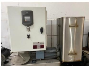
**Ilustración 63** Molino coloidal para el ensayo
