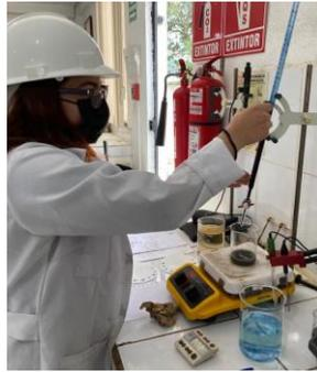
**Ilustración 28** Ensayo de Azul de Metileno
