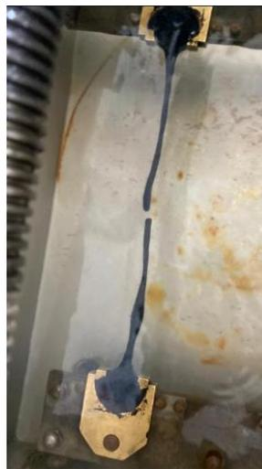
**Ilustración 42** Toma de medida para ensayo de recuperación por Ductilidad
