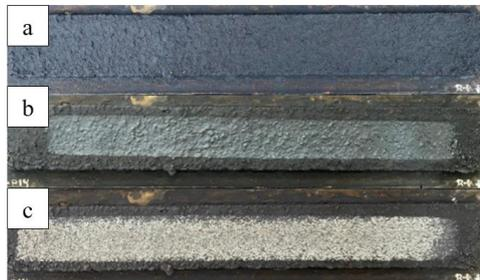
**Ilustración 147** Resultados del ensayo de rueda cargada mina Rookaazul-CQS-1H-P a) Muestra seca antes del ensayo b) Muestra seca después del ensayo, 1000 ciclos c) Muestra seca después del ensayo, 100 ciclos con arena Ottawa.
