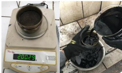
**Ilustración 73** Tamizando muestra por tamiz N.º 20
