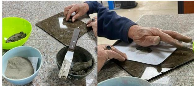
**Ilustración 11** Elaborando hilo con una porción de muestra
