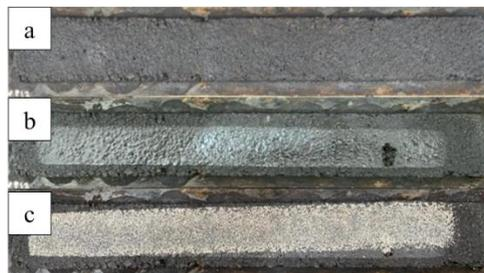
**Ilustración 150** Resultados del ensayo de rueda cargada mina vipesa-CQS-1H-P a) Muestra seca antes del ensayo b) Muestra seca después del ensayo, 1000ciclos c) Muestra seca después del ensayo, 100 ciclos con arena Ottawa.
