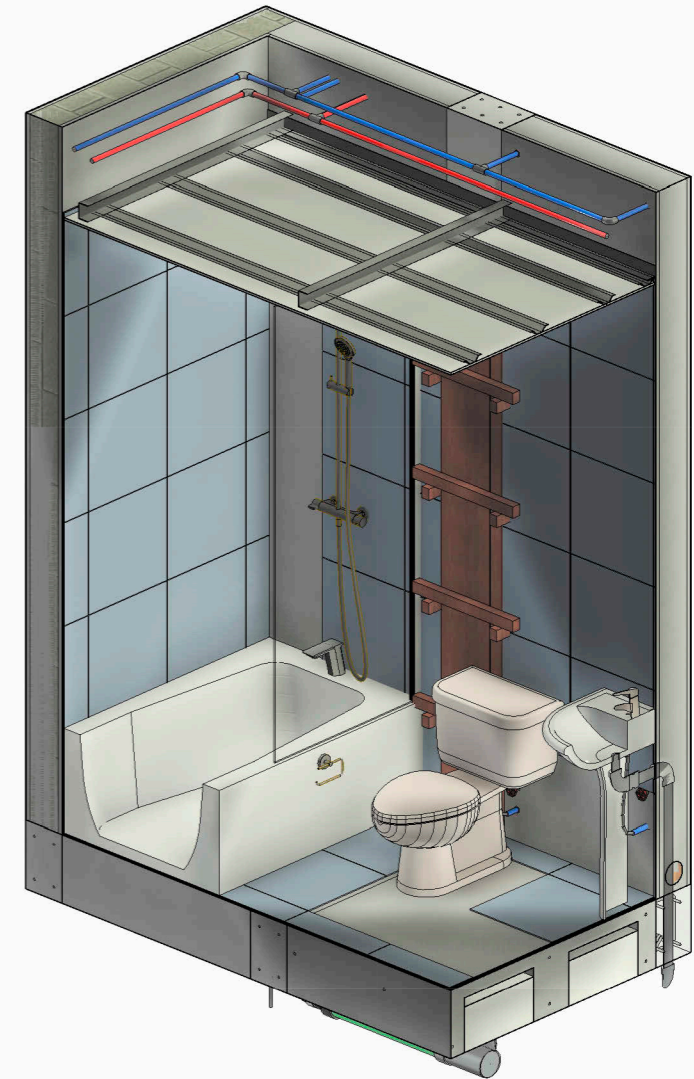
DETALLE 3D DE CONFORMACIÓN DE BAÑO ESC: 1:20
