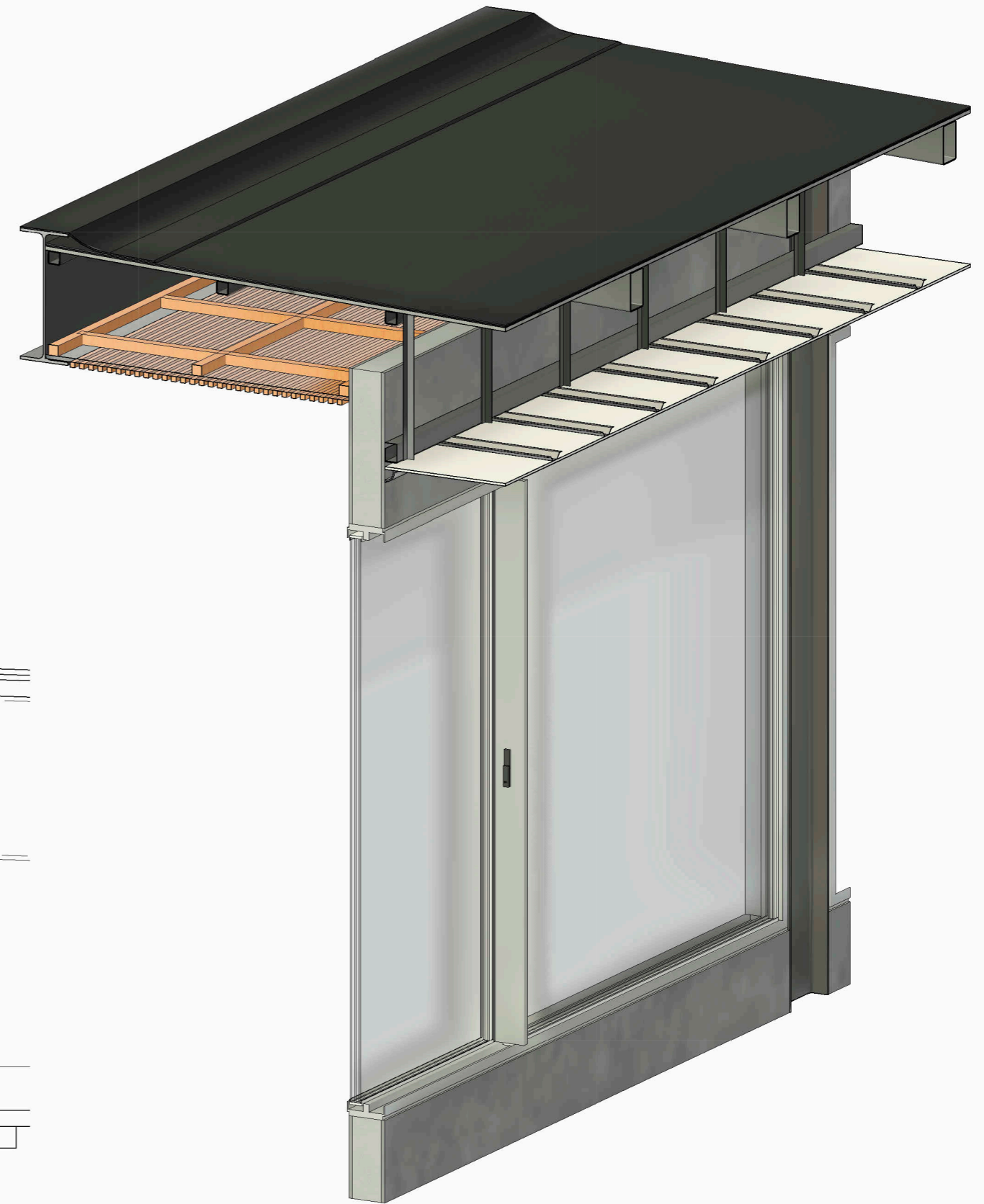
DETALLE 3D DE CONFORMACIÓN DE CUBIERTA ESC: 1:20
