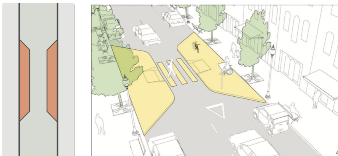
FIGURA 3.62: Ejemplo de embudo en paso cebra. Pp. 133
