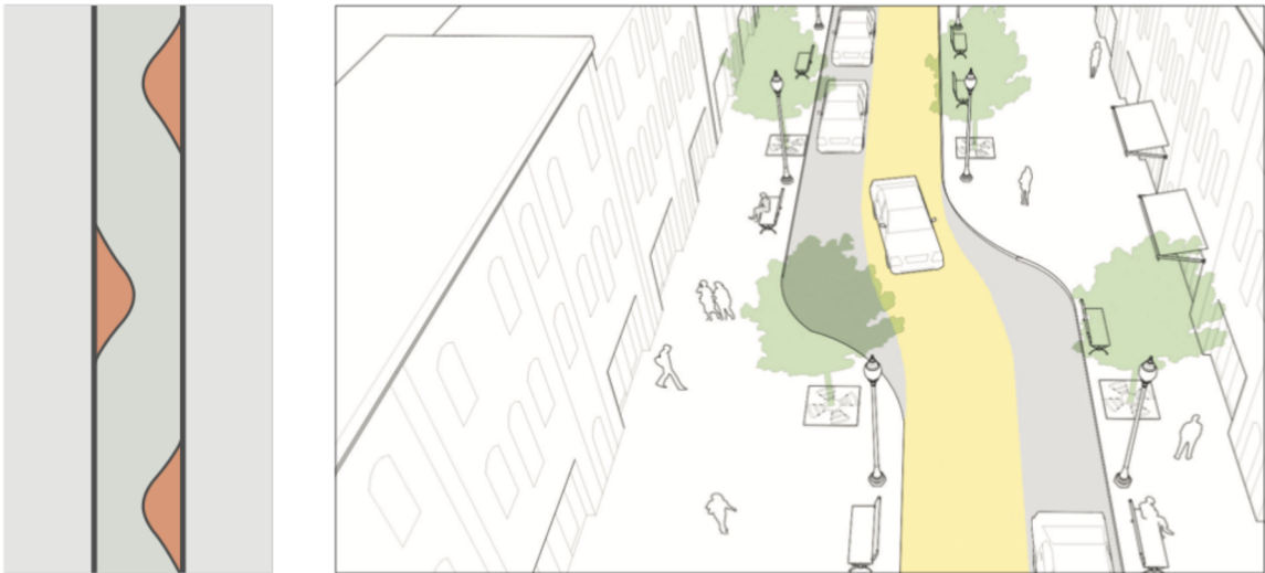
FIGURA 3.64: Ejemplo de chicanas y cambios de línea. Pp. 133
