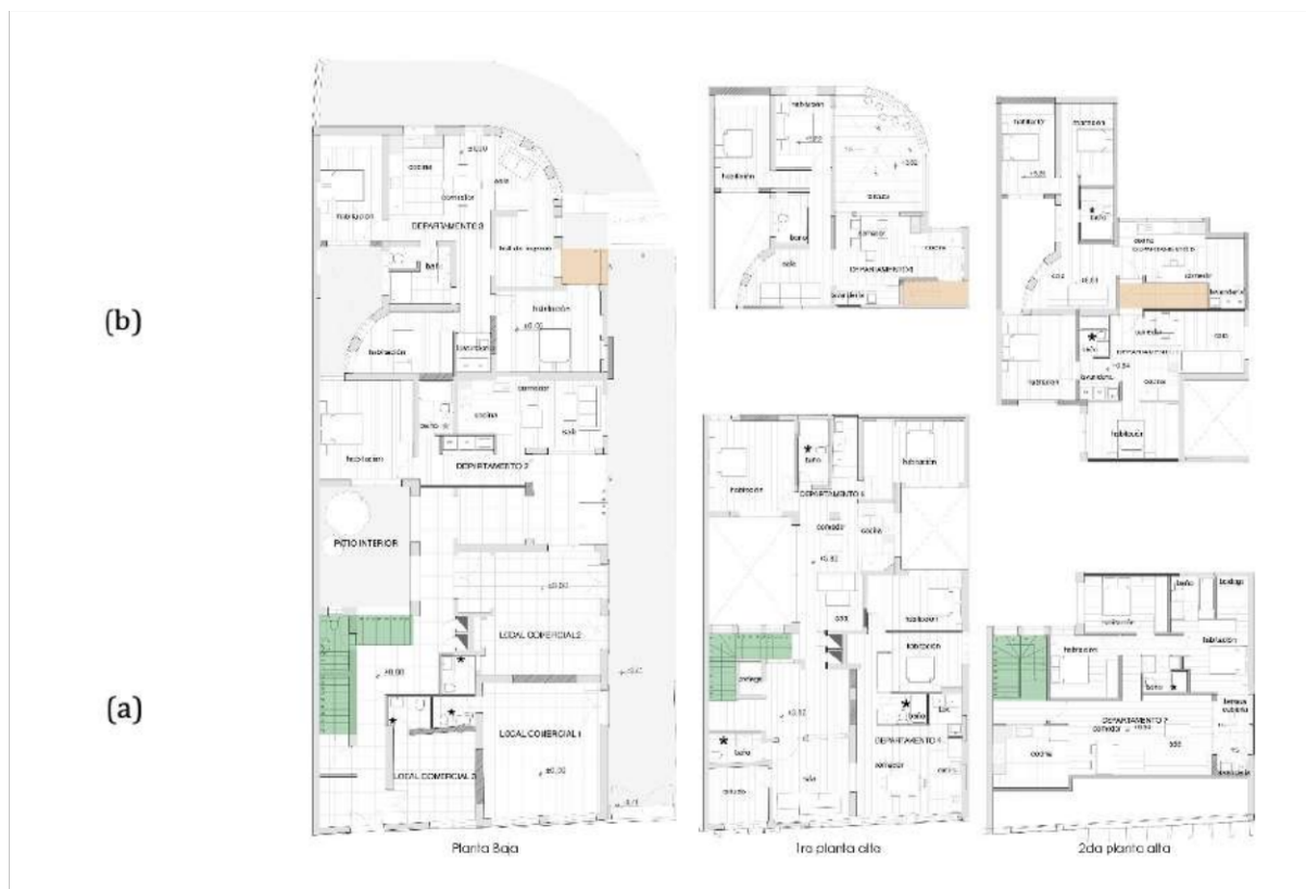
FIGURA 2.41: Circulación vertical en el bloque 1 del conjunto habitacional casa Cordero // (Surrealestudio, 2021).
