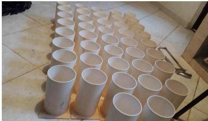
Imagen 2.- Moldes listos para colocar el hormigón. Fuente: (C.C."Autor", 2019)
