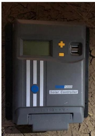
Figura 22 Controlador MPPT120D. Fuente (Miguel Siguencia, Santiago Salto, Autor).
