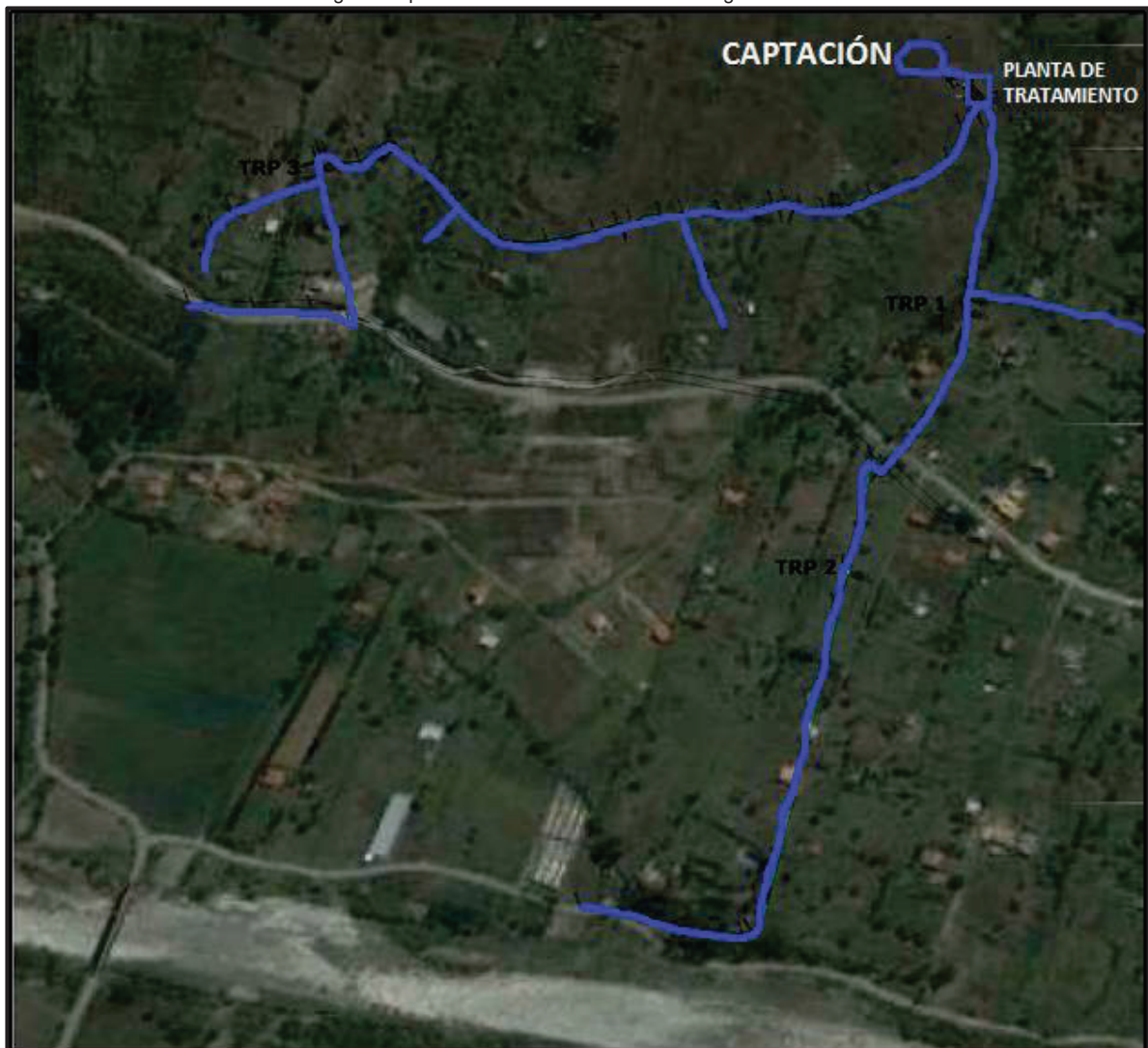
Fig. 24. Implantación General del Sistema de Agua Potable
