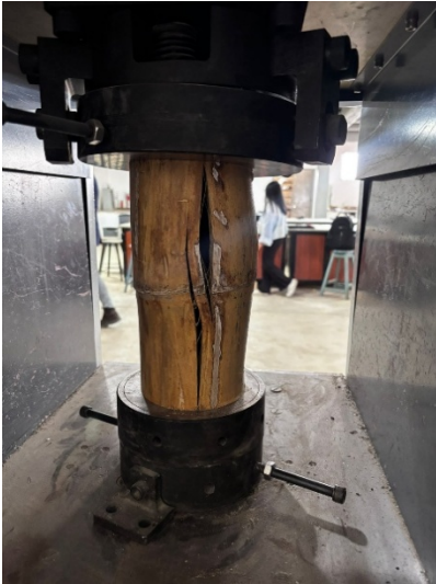
Figura 14. Ensayo de bambú compresión
