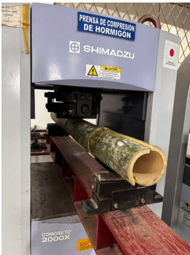
Figura 12. Ensayo de bambú a flexión
