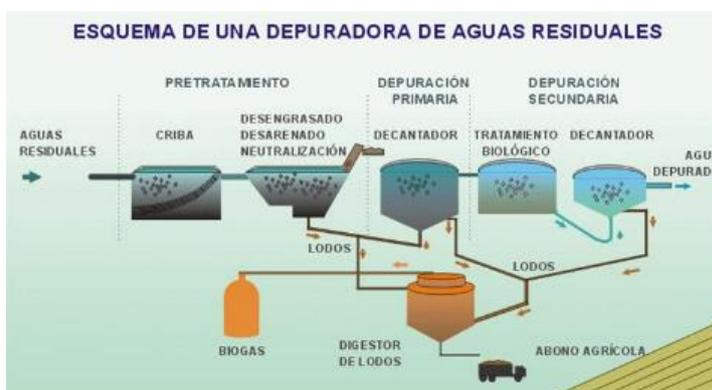
**Figura 12:** Esquema típico de planta de tratamiento de agua
