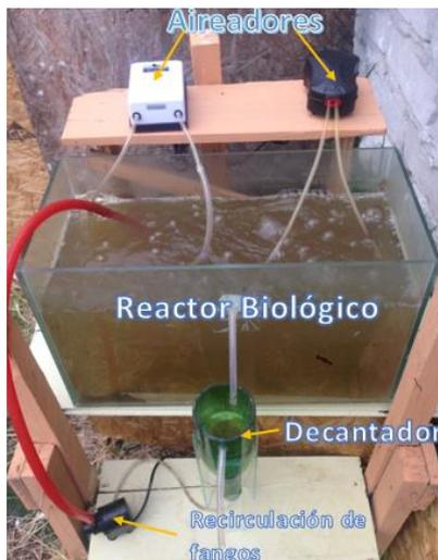
**Figura 14:** Planta piloto del proceso biológico
