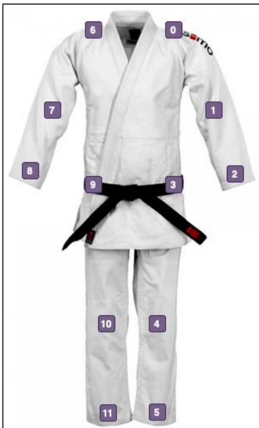
Anexo 5: Disposición de los acelerómetros en el traje.
