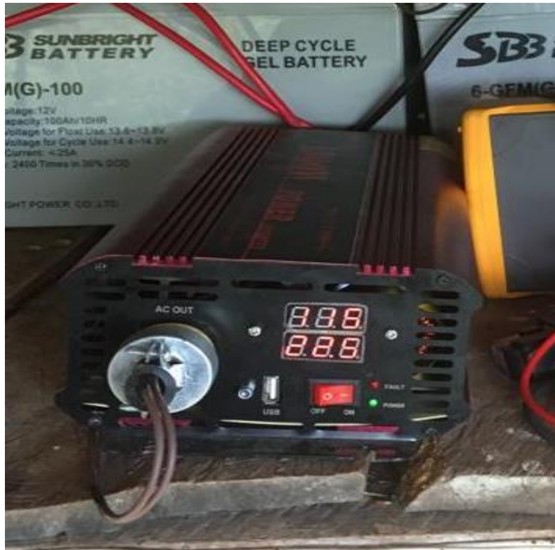
Figura 27. Inversor Zonhan 1500W
