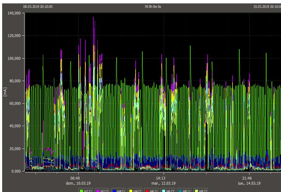
Figura 44. Distorsión armónica de corriente de orden par
