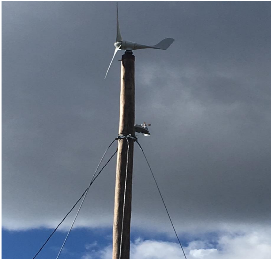
Figura 24. Aerogenerador Zonhan de 600W
