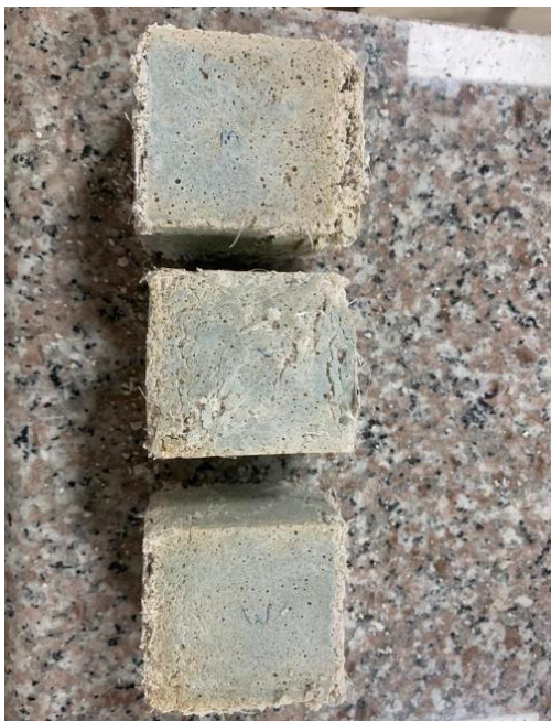
Figura 59 Comportamiento de especímenes posterior al ensayo a compresión. 6% F, a/c: 0.72
