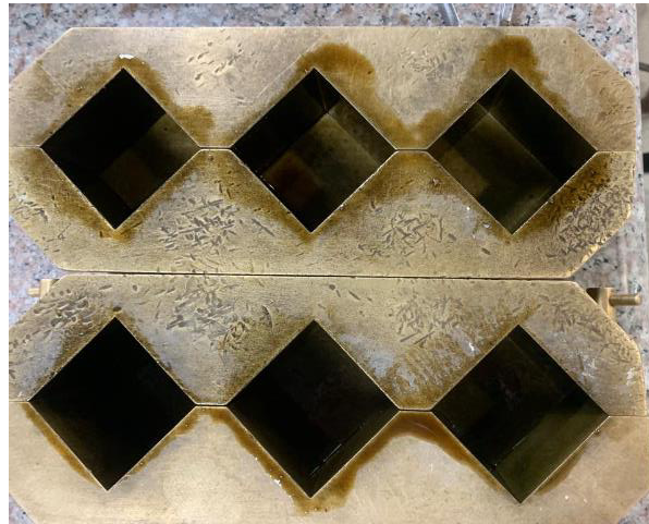
Figura 19 Moldes para los especímenes 50 x 50 mm
