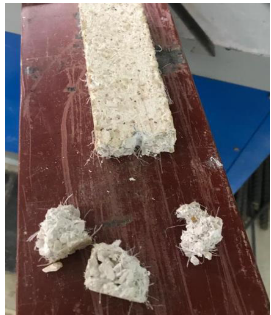
Figura 72 Desgarre de la placa al llegar al límite de peso soportado
