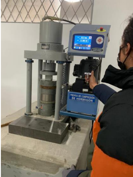
Figura 57 Colocación del espécimen en la prensa de compresión de hormigón
