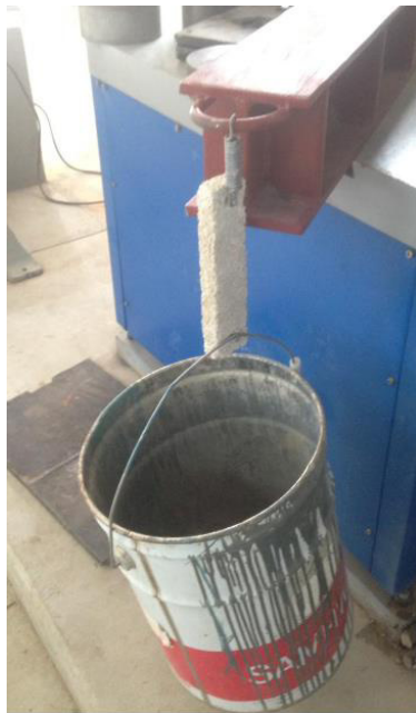
Figura 71 Modo de carga para obtener el peso máximo soportado por la placa
