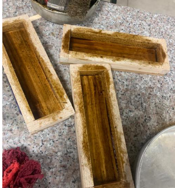
Figura 66 Agregado de desencofrante a placas de 20 x 5 cm
