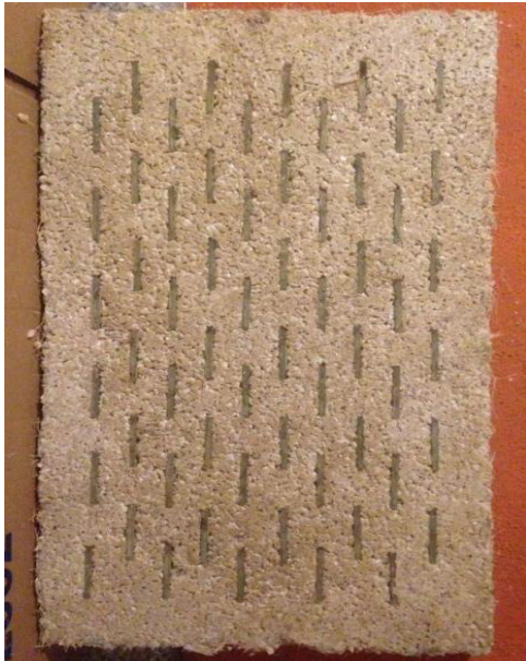
Figura 69 Desencofrado y pulido de placa translúcida
