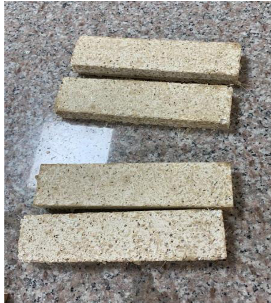
Figura 70 Desencofrado de placas de 20 x 5 cm
