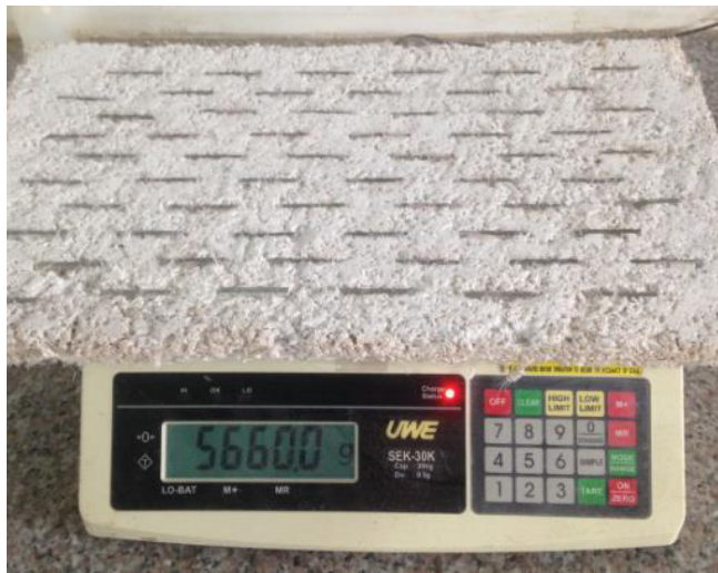
Figura 38 Peso de la placa después del ensayo
