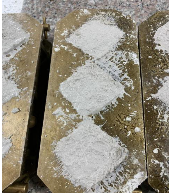
Cubos de mortero obtenidos de la primera dosificación
