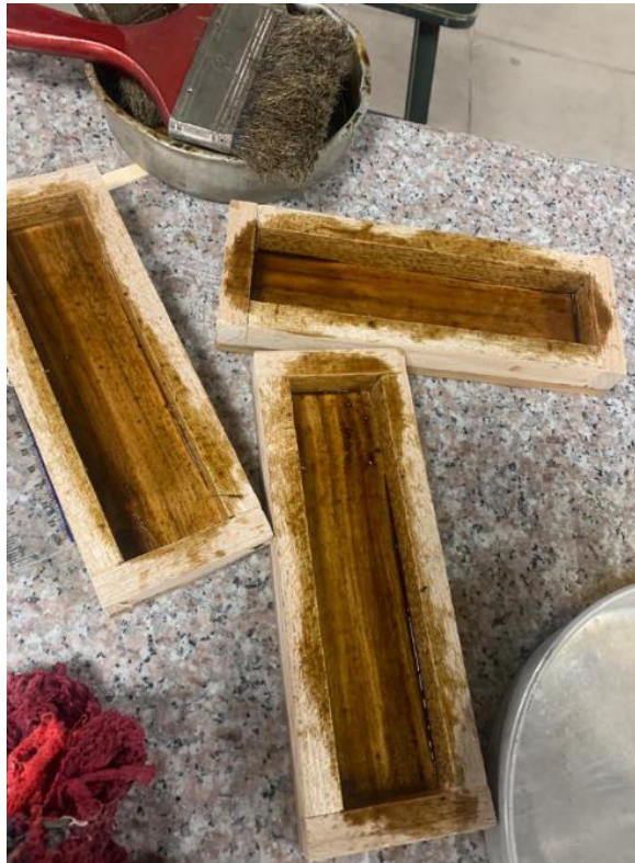
Figura 23 Moldes de madera de 200 x 50 mm, e = 20 mm
