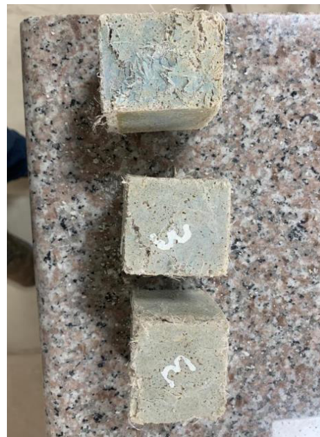
Figura 60 Comportamiento de especímenes posterior al ensayo a compresión. 3% F, a/c: 0.72
