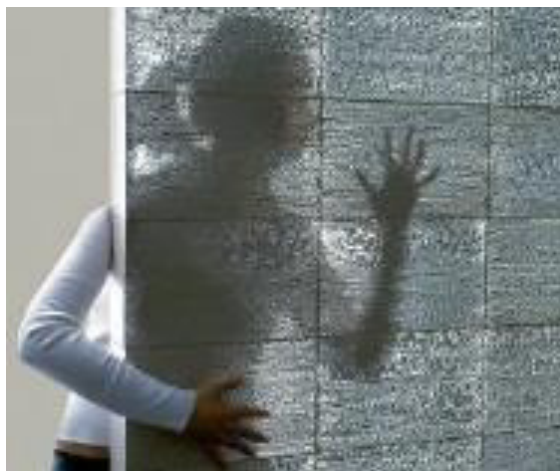
Figura 2 Muro de hormigón translucido LiTraCon
