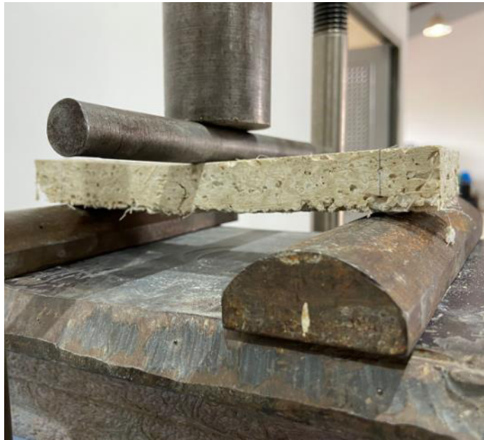
Figura 25 Ensayo a flexión, ubicación de la placa
