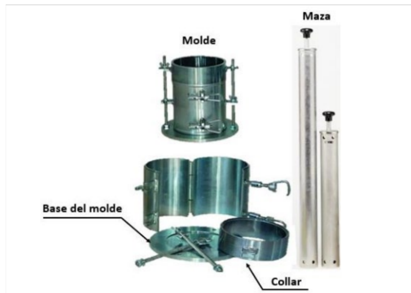
Figura 14 Equipo para realizar el ensayo Proctor en laboratorio.
