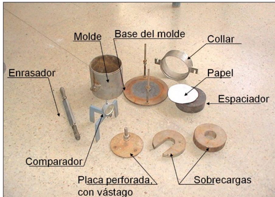
Figura 15 Equipo para ensayo de compactación CBR
