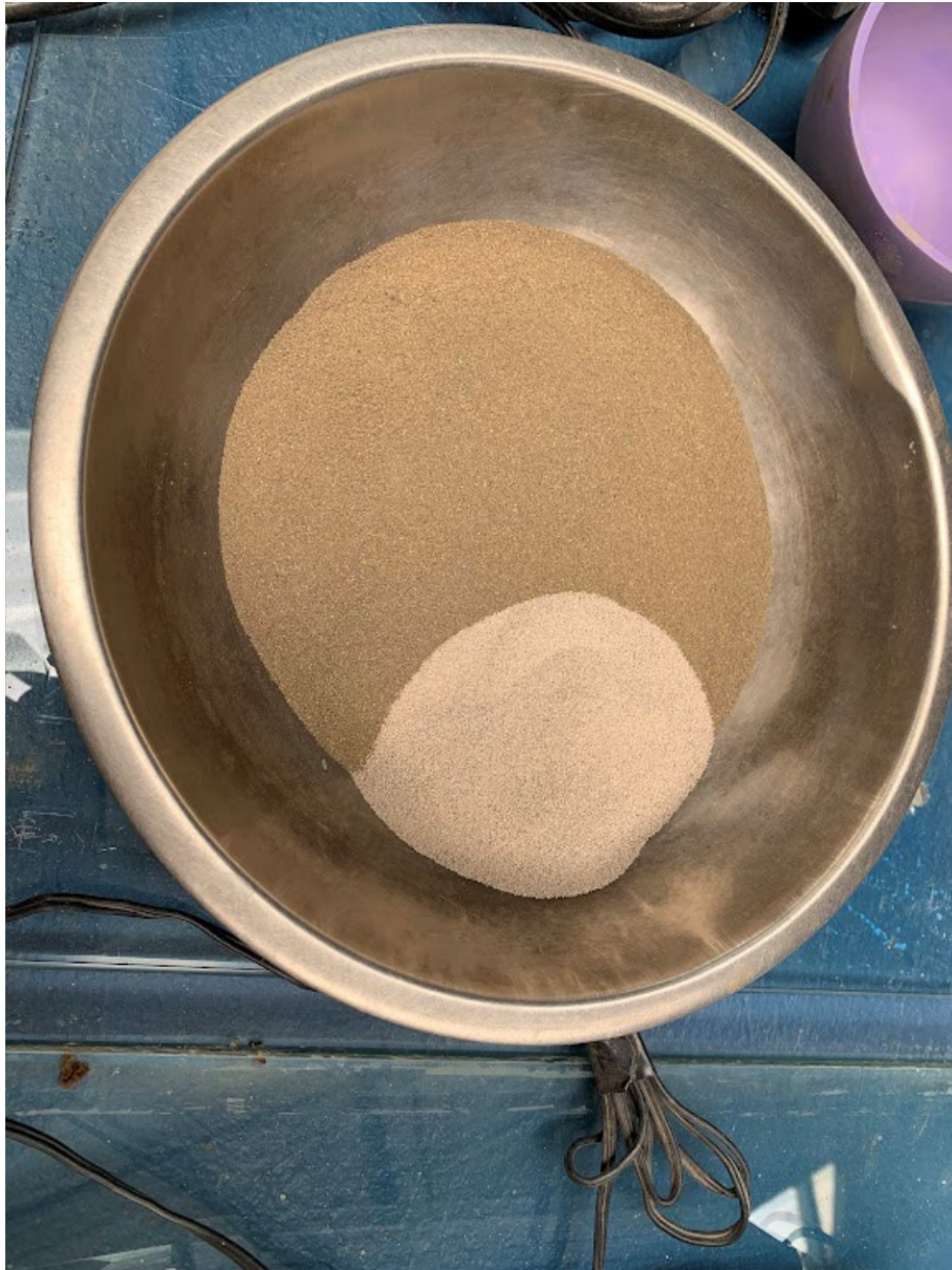
Figura 65 Material para ensayo de límites de Atterberg
