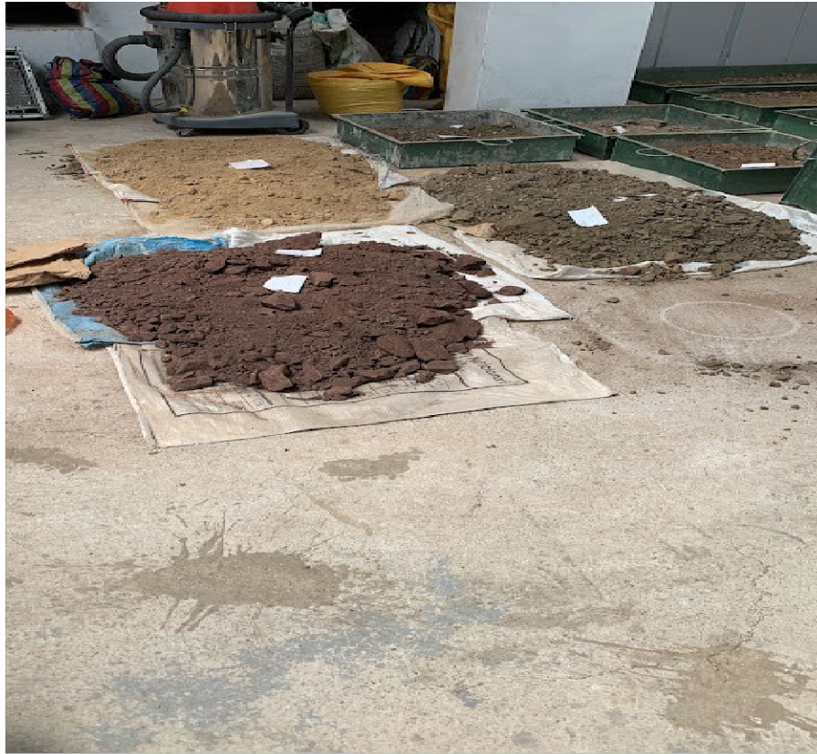
Figura 62 Tendido de material extraído
