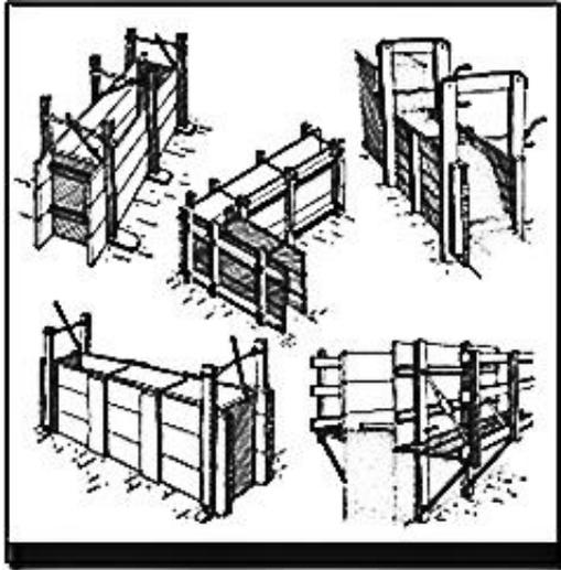
**Ilustración 79 Encofrados para la realización de muros de Tapial.**
