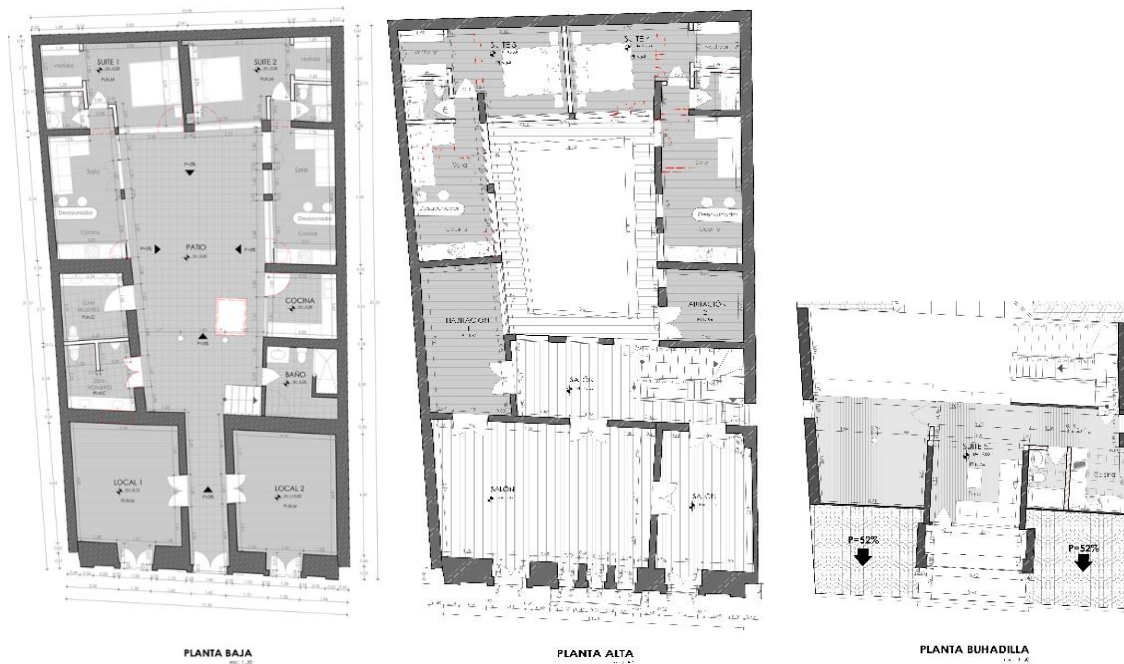
A B C Imagen N.3: Planta Baja, Planta Alta, Buhardilla (propuesta de intervención) Fuente; Pacurucu, 2015.
