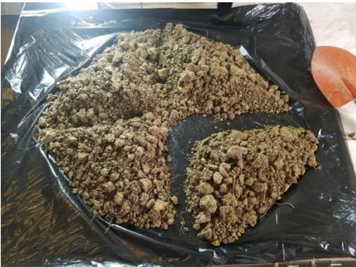
**Anexo 2:** Método del Cuarteo de la muestra previa a la obtención de la sub muestra para el análisis físico - químico.
