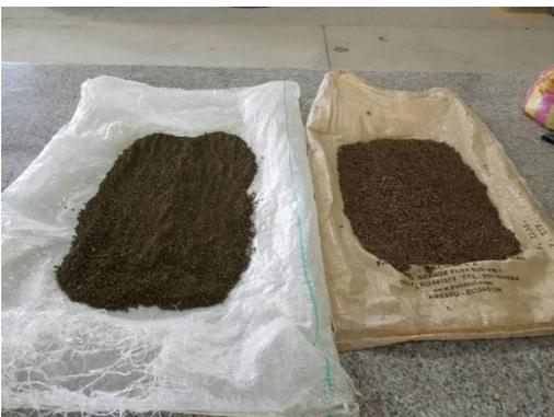
**Anexo 3:** Comparación de las muestras tamizadas, derecha suelo de la mina, izquierda suelo del ecosistema de referencia. Previo a determinación del tipo de suelo.
