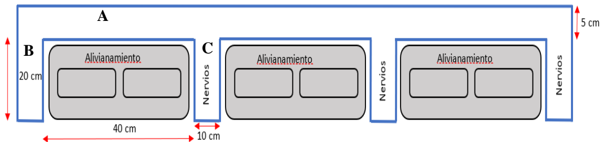
Figura 10: Esquema de la losa alivianada. Fuente: Autoría Propia
