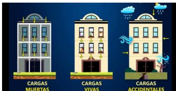
Figura 3: Tipos de cargas estructurales. Fuente: [21]
