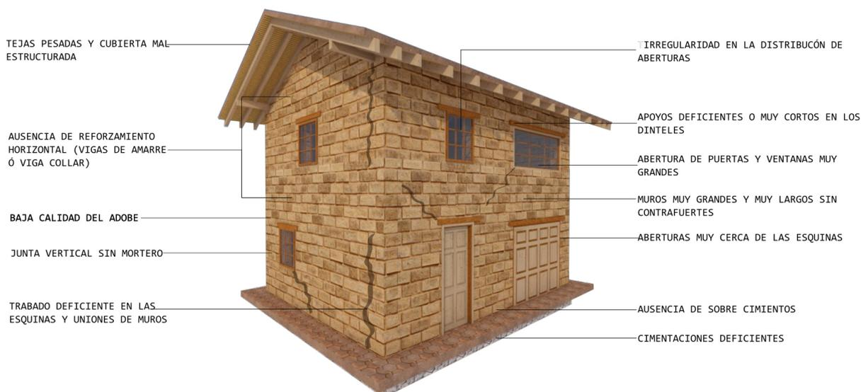
FIGURA 1.13: Principales mecanismos de falla en edificaciones de adobe de dos pisos
