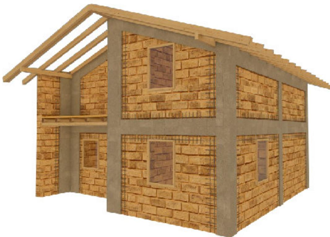
FIGURA 3.18: Sistema aporticado de refuerzo estructural con malla electrosoldada y revoque cementicio
