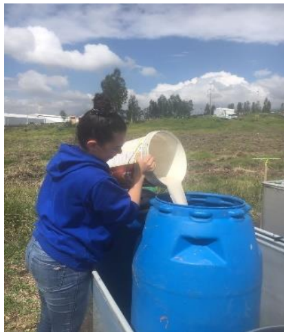
Figura 20. Disolución de la cal en agua
