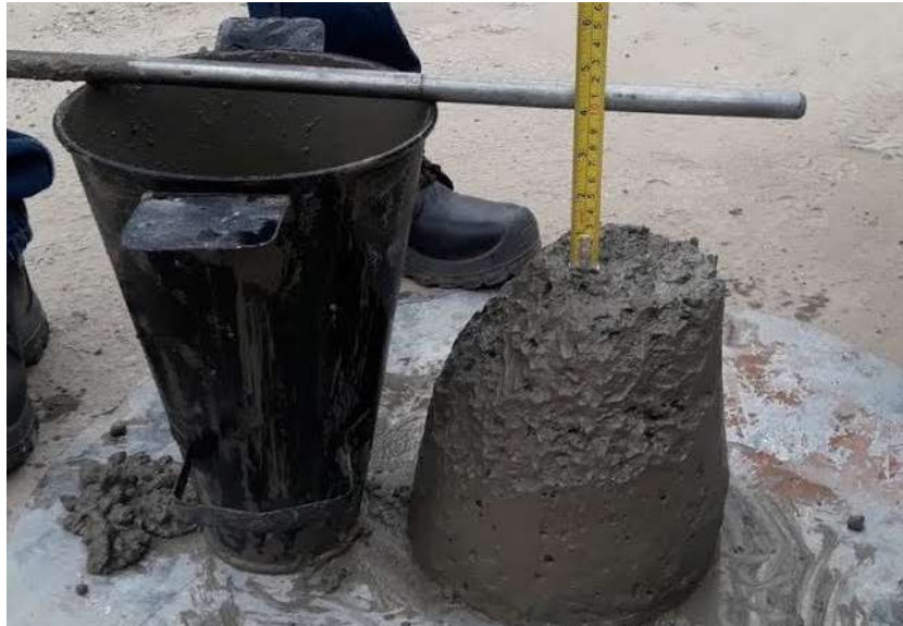
Ilustración 2 Ensayo de asentamiento
