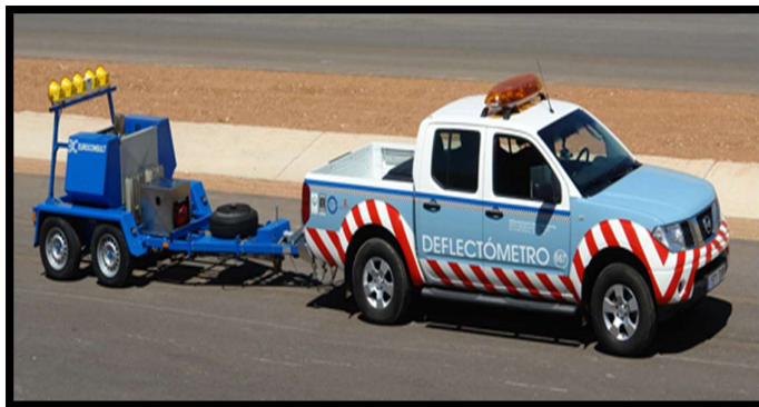
Figura 16: Deflectómetro de Impacto.
