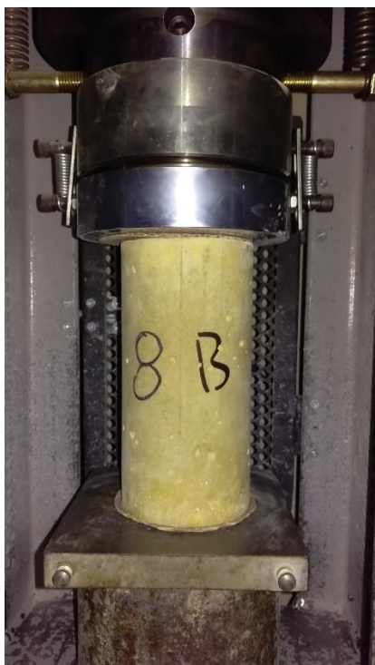
Fotografía: Cilindro hormigón con cemento blanco 8 % pigmento amarillo Fuente: Paúl Guzmán
