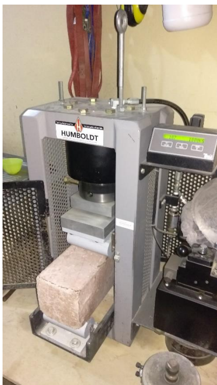
Fotografía: Ensayo de flexión, cemento blanco 6% pigmento rojo Fuente: Paúl Guzmán Elaboración: Paúl Guzmán
