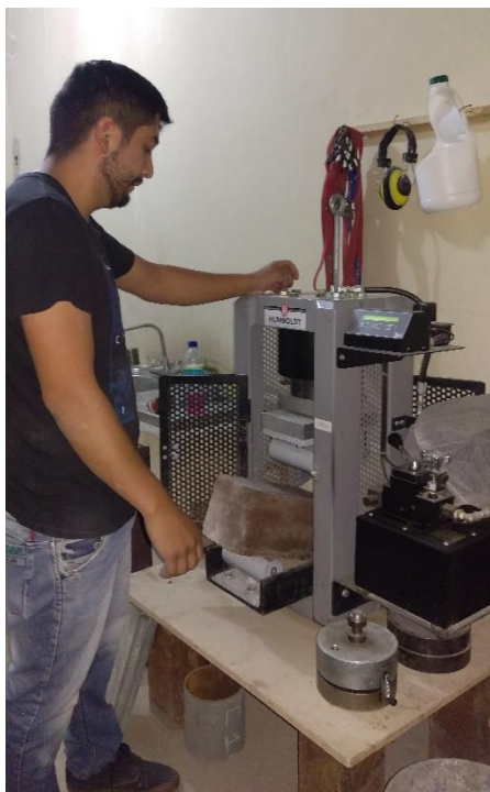
Fotografía: Ensayo de flexión, cemento gris 8% pigmento rojo Fuente: Paúl Guzmán Elaboración: Paúl Guzmán
