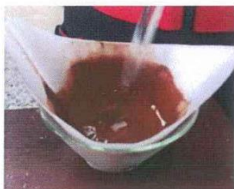
Fotografía: Primer lavado con agua des ionizada caliente Fuente: Paúl Guzmán Elaboración: Paúl Guzmán
