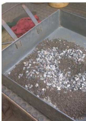
Fotografía: Mezcla de hormigón con triturado 3/8 Fuente: Paúl Guzmán Elaboración: Paúl Guzmán
