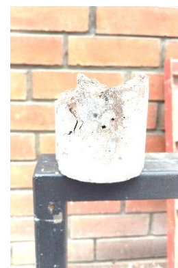
Fotografía 41: Cilindro con 2.5 % de plastificante en relación al cemento Fuente: Paúl Guzmán Elaboración: Paúl
