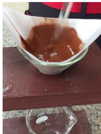
Fotografía: Primer lavado con agua des ionizada caliente Fuente: Paúl Guzmán Elaboración: Paúl Guzmán
