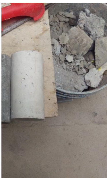
Fotografía: Cilindros de hormigón con cemento blanco Fuente: Paúl Guzmán Elaboración: Paúl Guzmán
