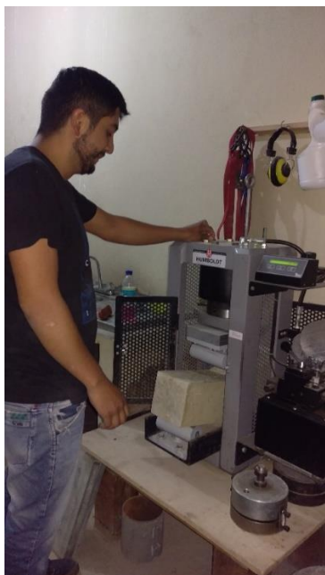
Fotografía: Ensayo de flexión, cemento blanco 6% pigmento amarillo Fuente: Paúl Guzmán Elaboración: Paúl Guzmán
