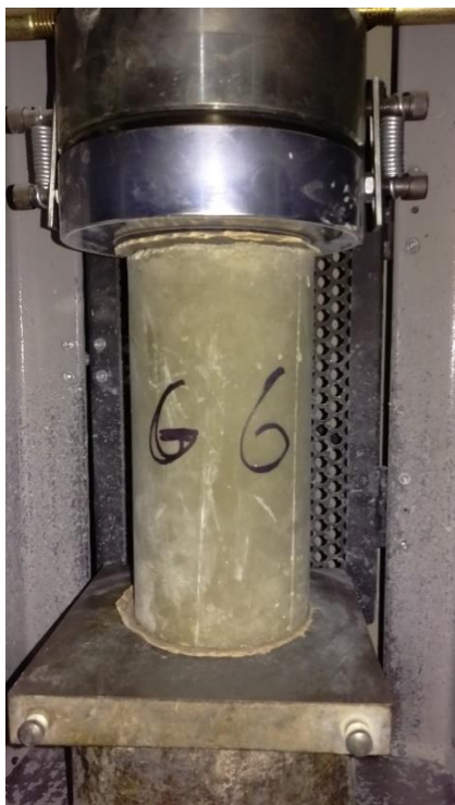
Fotografía: Cilindro hormigón con cemento gris 6 % pigmento amarillo Fuente: Paúl Guzmán Elaboración: Paúl Guzmán
