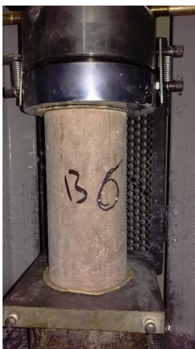
Fotografía: Cilindro hormigón con cemento blanco 6 % pigmento rojo Fuente: Paúl Guzmán Elaboración: Paúl Guzmán
