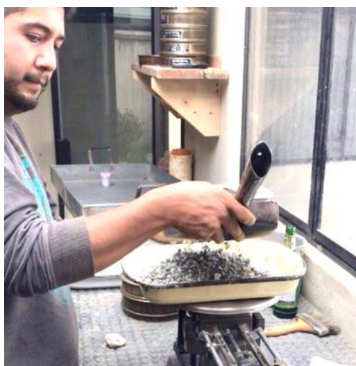
Fotografía 44: Pesado del agregado de 3/8
