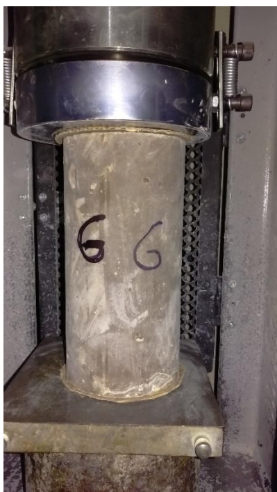
Fotografía: Cilindro hormigón con cemento gris 6 % pigmento rojo Fuente: Paúl Guzmán Elaboración: Paúl Guzmán
