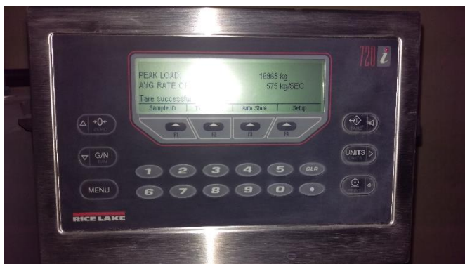
Fotografía: Carga de rotura en kilogramos Fuente: Paúl Guzmán Elaboración: Paúl Guzmán
