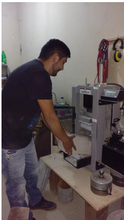
Fotografía: Ensayo de flexión, cemento blanco puro Fuente: Paúl Guzmán Elaboración: Paúl Guzmán
