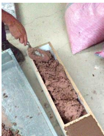
Fotografía 54: Elaboración de vigas con pigmento rojo Fuente: Paúl Guzmán Elaboración: Paúl Guzmán
