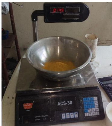
Fotografía: Peso de 6 % de pigmento para diseño de hormigón con triturado de 3/4 Fuente: Paúl Guzmán Elaboración: Paúl Guzmán
