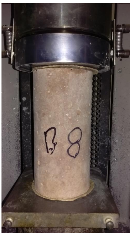
Fotografía: Cilindro hormigón con cemento gris 8 % pigmento amarillo. Fuente: Paúl Guzmán Elaboración: Paúl Guzmán
