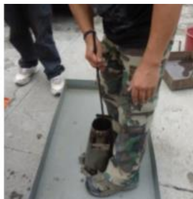
Fotografías 39: Ensayo de asentamiento Fuente: Paúl Guzmán Elaboración: Paúl Guzmán
