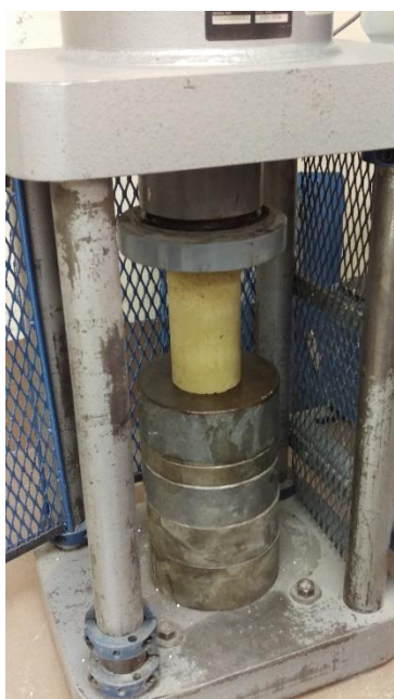
Fotografía: Cilindros de hormigón con cemento blanco con 8 % de pigmento amarillo. Fuente: Paúl Guzmán Elaboración: Paúl Guzmán
