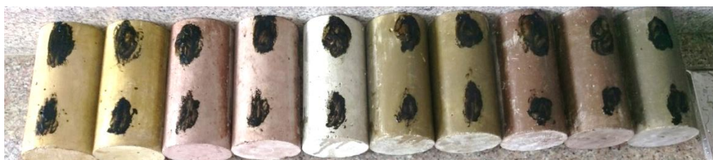
Fotografía 63: Probetas después de 24 horas de haber sido manchadas Fuente: Paúl Guzmán Elaboración: Paúl Guzmán
