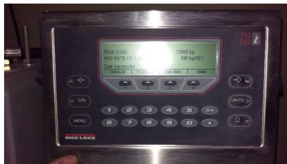
Fotografía 53: Carga de rotura en kilogramos
