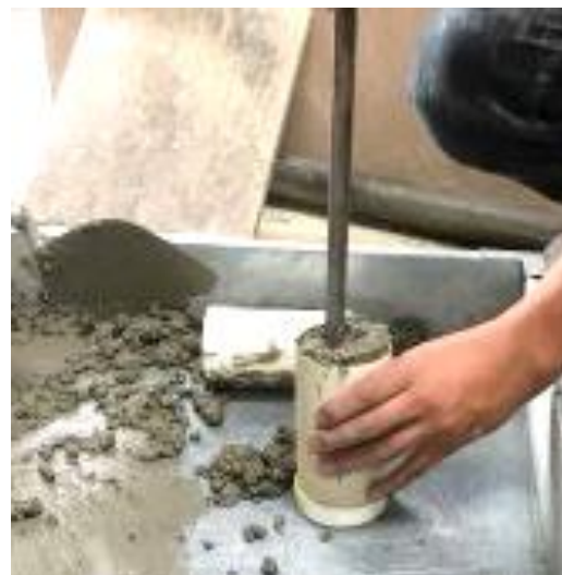
Fotografía 45: Varillado de probetas
