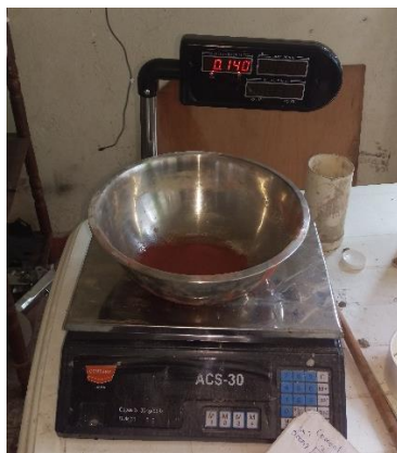
Fotografía: Peso de 8 % de pigmento para diseño de hormigón con triturado de 3/4 Fuente: Paúl Guzmán Elaboración: Paúl Guzmán
