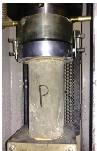
Fotografía 52: Cilindro hormigón con cemento gris
