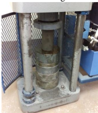
Fotografía 47: Cilindros de hormigón con cemento gris.
