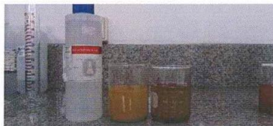
Fotografía pigmento mezclado con 150 ml de agua des ionizada y 10 ml de hidróxido de sodio. Fuente: Paúl Guzmán Elaboración: Paúl Guzmán
