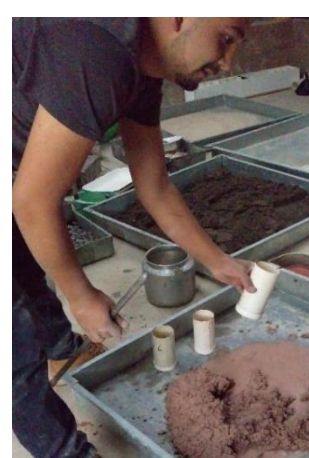
Fotografía: elaboración de cilindros con triturado de 3/8 Fuente: Paúl Guzmán Elaboración: Paúl Guzmán
