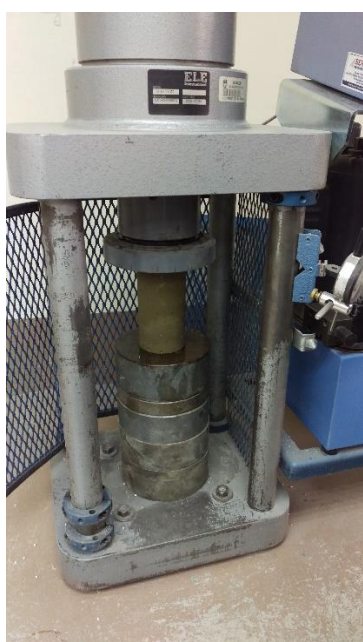
Fotografía: Cilindros de hormigón con cemento gris con 6 % de pigmento amarillo. Fuente: Paúl Guzmán Elaboración: Paúl Guzmán
