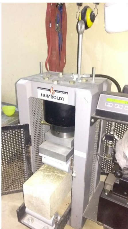
Fotografía: Ensayo de flexión, cemento gris 8% pigmento amarillo Fuente: Paúl Guzmán Elaboración: Paúl Guzmán
