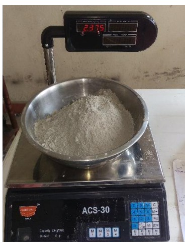
Fotografía: Peso del cemento gris para diseño de hormigón con triturado de 3/4 Fuente: Paúl Guzmán Elaboración: Paúl Guzmán
