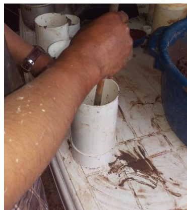
Fotografía: varillado de probeta Fuente: Paúl Guzmán Elaboración: Paúl Guzmán
