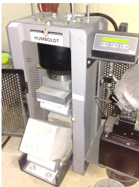
Fotografía 56: Ensayo de flexión, cemento gris puro Fuente: Paúl Guzmán Elaboración: Paúl Guzmán
