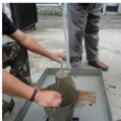
Fotografías 38: Ensayo de asentamiento Fuente: Paúl Guzmán Elaboración: Paúl Guzmán
