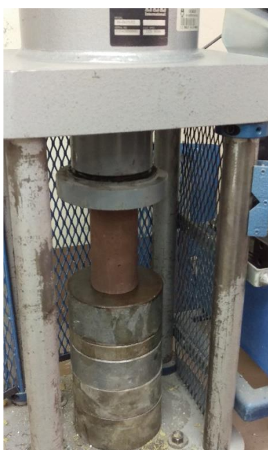
Fotografía: Cilindros de hormigón con cemento gris con 8 % de pigmento rojo. Fuente: Paúl Guzmán Elaboración: Paúl Guzmán
