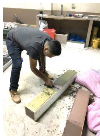
Fotografía 55: Elaboración de vigas con pigmento amarillo Fuente: Paúl Guzmán Elaboración: Paúl Guzmán
