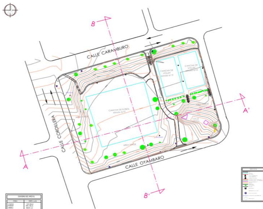
Plano N° 1 Levantamiento Estado Actual
