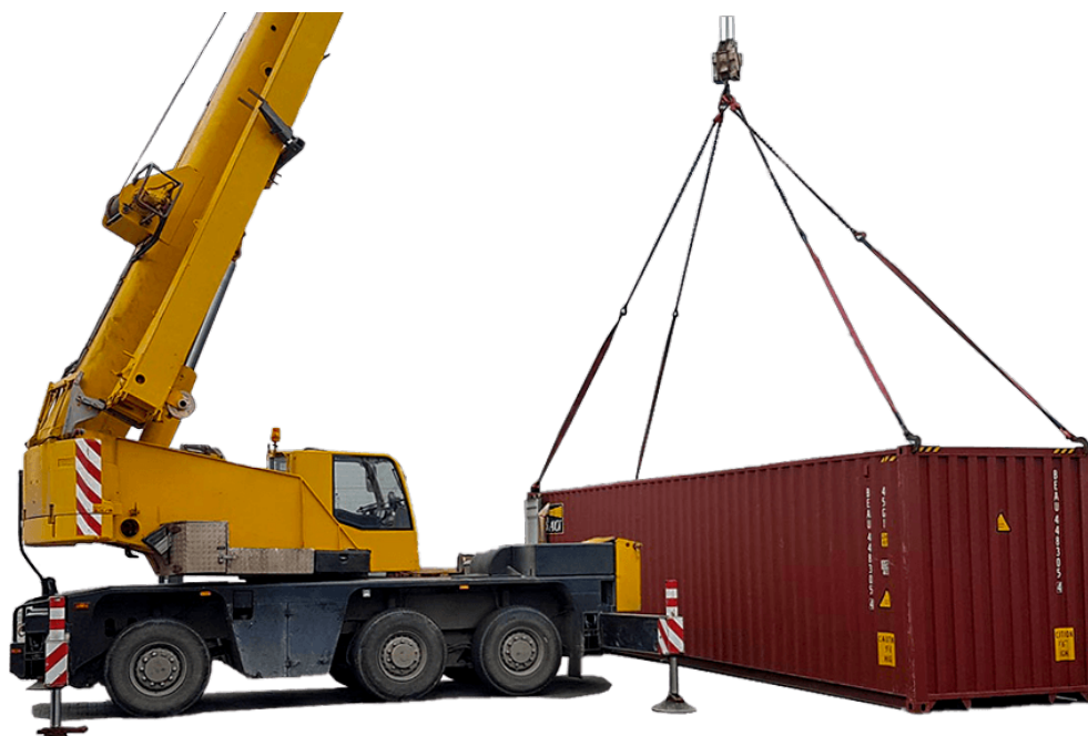
Figura 27: Proceso convencional de levantamiento de contenedores marítimos a través de grúas
