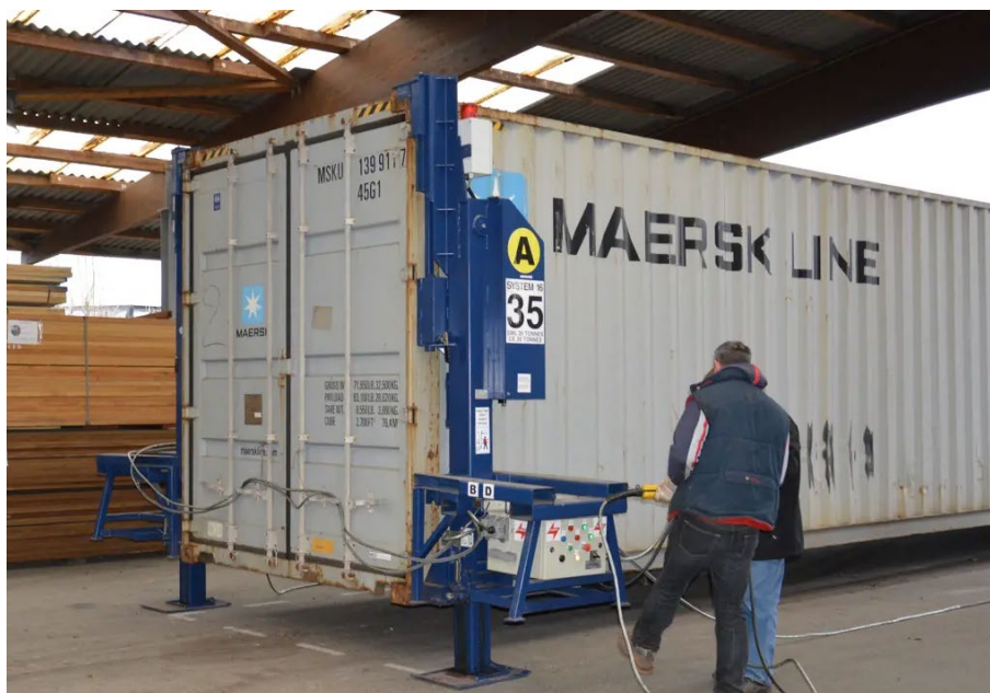
Figura 26: Elevación de contenedor a través de sistema hidráulico
