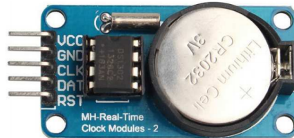
Figura 2.7: Módulo RTC DS1302
