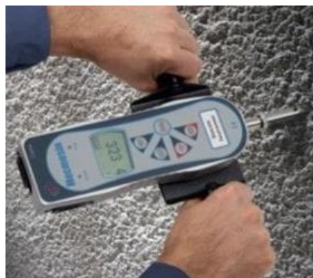
Figura 42. Ensayo con penetrómetro
