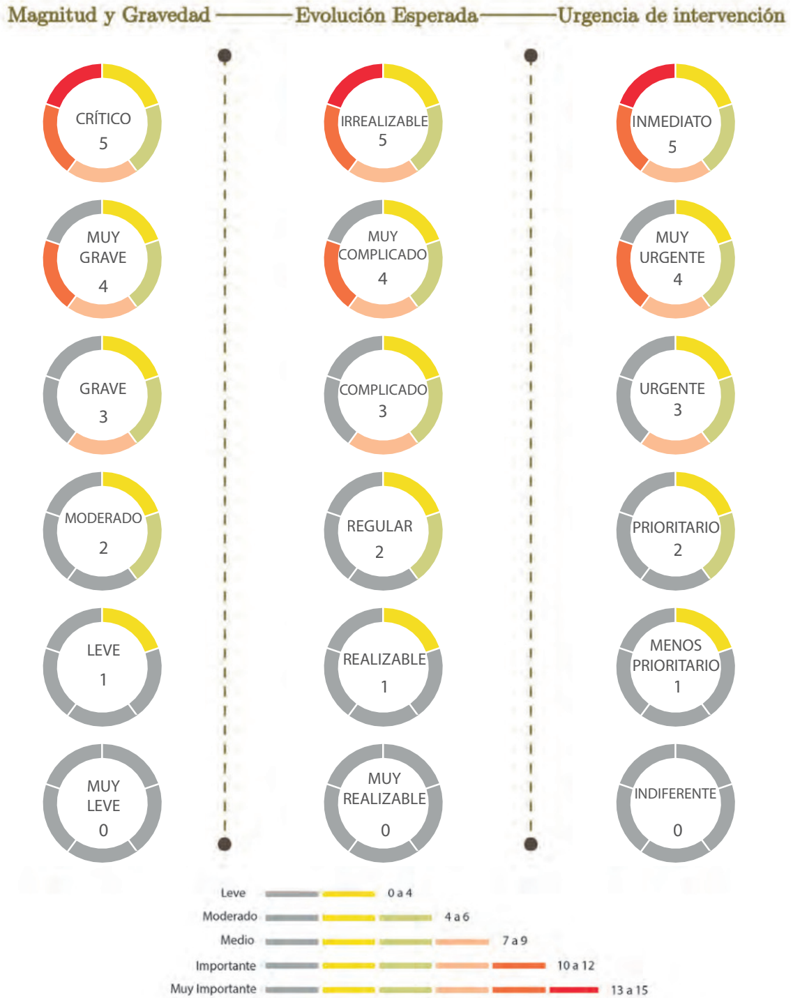
FIGURA 3.4.1. Valorización de Problemas
