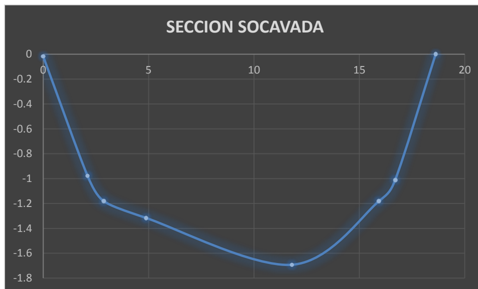
Imagen 19: Sección socavada Fuente: Tesista Héctor Calle
