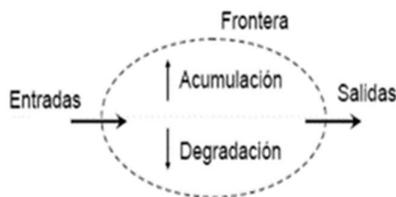
Figura 11. Esquema balance de materia
