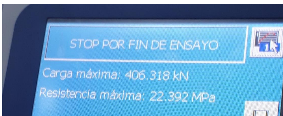
Figura: 83. Resultados del ensayo a compresión del cilindro 2.
