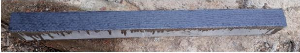
Figura: 80. Viga reforzada con Fibra de Carbono (SikaWrap 600C)
