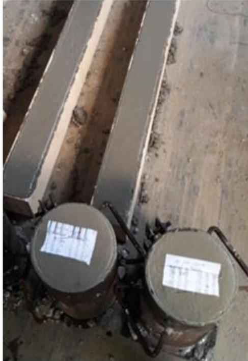
Figura: 76. Toma de muestra de hormigón para verificar su resistencia Fuente: Autor
