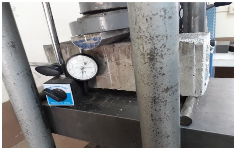
Figura: 84. Ensayo a compresión de la viga sin refuerzo
