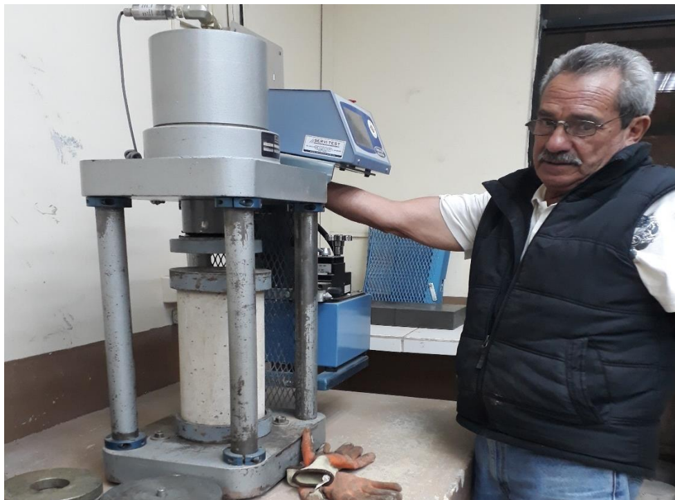
Figura: 81. Rotura de los cilindros de hormigón en la prensa hidráulica del Laboratorio de Suelos de la Universidad Católica de Cuenca
