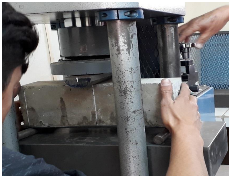
Figura: 85. Ensayo a compresión de la viga reforzada con CFRP
