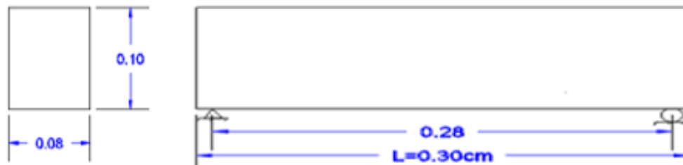
Figura: 73. Sección de las vigas a construir
