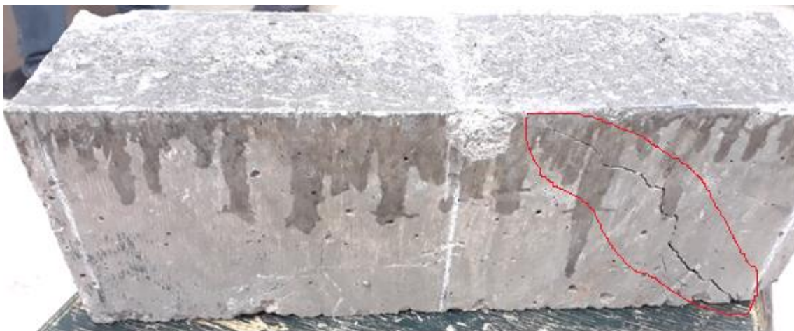
Figura: 87. Resultado visual de la viga sin CFRP.
