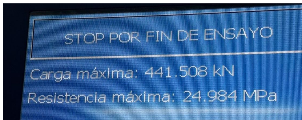
Figura: 82. Resultados del ensayo a compresión del cilindro 1.
